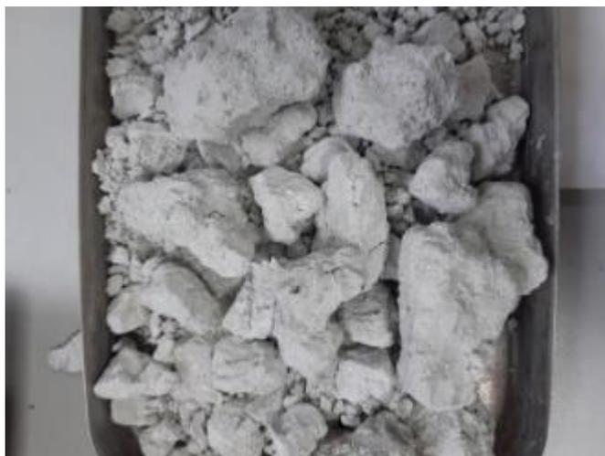
Рисунок 3.18 – Проба МПСП, высушенная до постоянной массы
