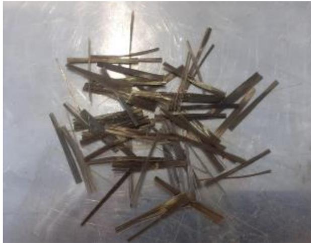
Рисунок 5.11 – Базальтовая фибра, используемая в экспериментах
