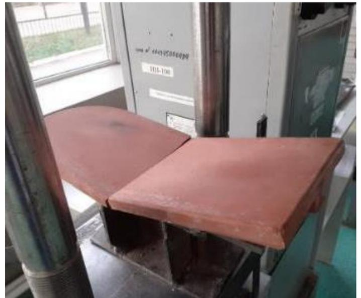
Рисунок 5.10 – Испытание цементно-песчаной черепицы на изгиб
