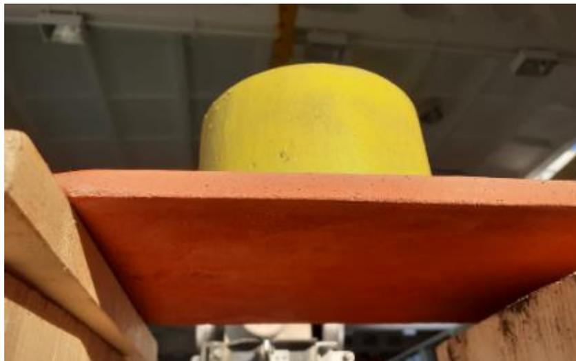
Рисунок 5.17 – Результат испытания черепицы на водонепроницаемость (через 48 часов после начала испытаний протечки воды и увлажнение нижней поверхности черепицы отсутствовали)
