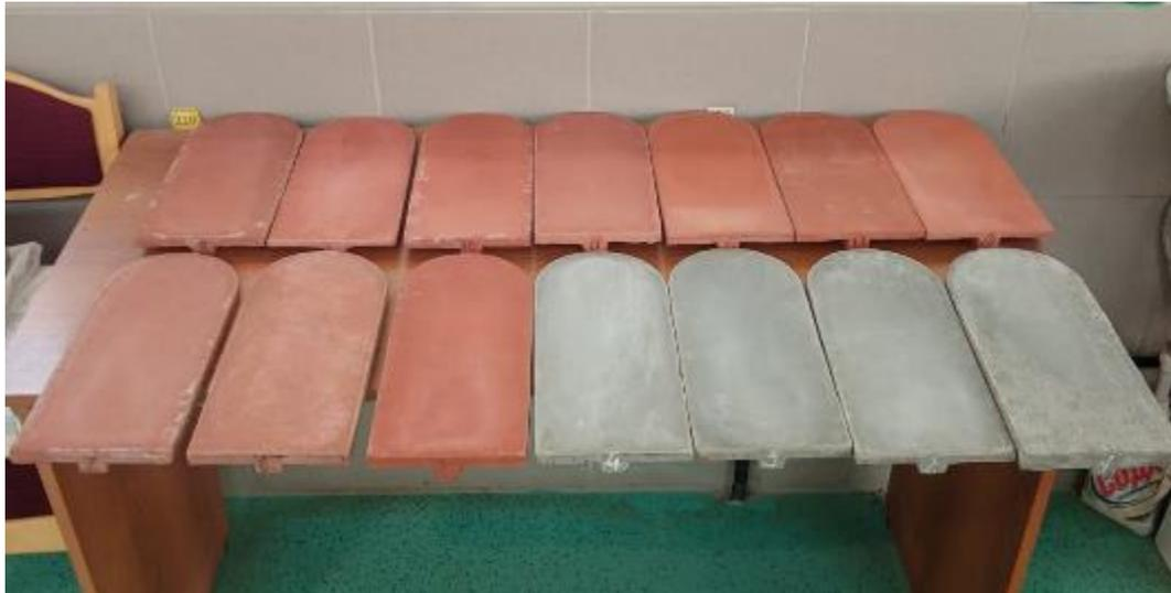
Рисунок 5.8 – Пробные образцы цементно-песчаной черепицы, изготовленные при отработке состава смеси и технологии прессования
