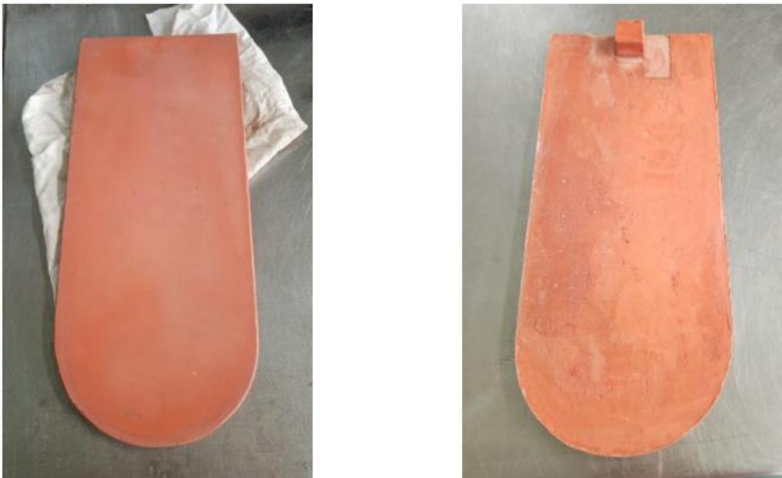
Рисунок 5.14 – Верхняя (лицевая) и нижняя поверхности цементно-песчаной черепицы, изготовленной по технологии фильтрационного прессования с раздельно-последовательной подачей смеси
