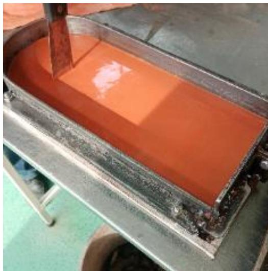
Рисунок 5.6 – Высокоподвижная растворная смесь в нижней части формы (матрице)
