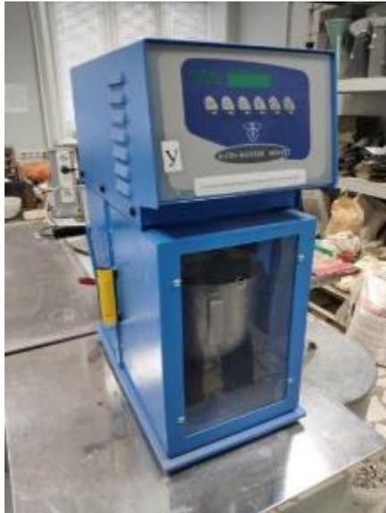
Рисунок 3.2 – Смеситель лабораторный для замешивания цементно-песчаной смеси
