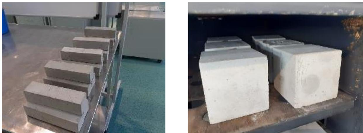
Рисунок 3.15 – Образцы-балочки и образцы-кубы, изготовленные по литьевой технологии с виброуплотнением
