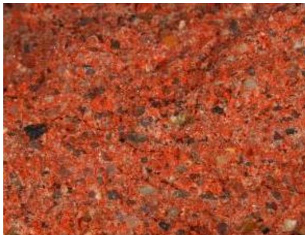
Рисунок 4.7 - Фотографии структуры цементно-песчаных композитов, полученных по технологии ФП (увеличение 20 раз)
