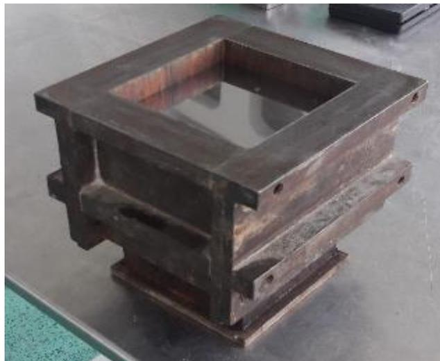
Рисунок 3.13 – Общий вид пресс-формы для изготовления образцов-пластин размером 100×100мм
