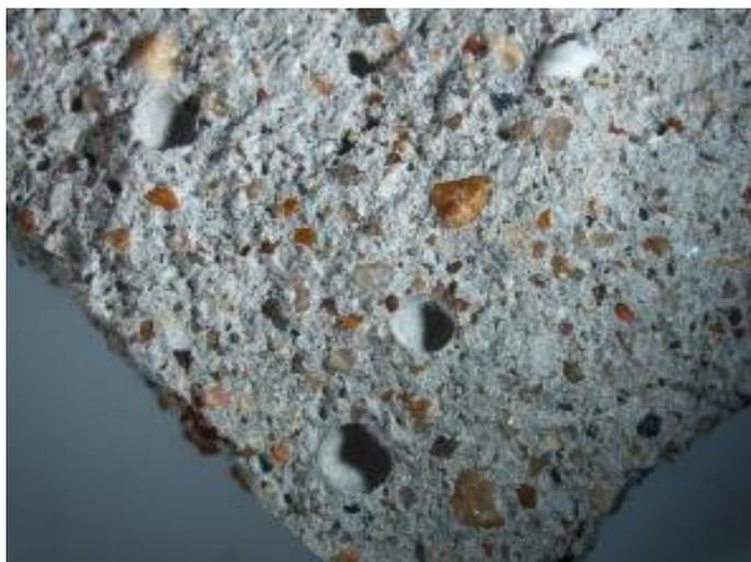
Рисунок 4.8 - Фотография структуры цементно-песчаного композита, полученного по литьевой технологии (увеличение 20 раз)
