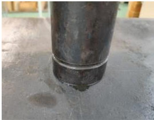
Рисунок 3.10 – Отделение воды в процессе фильтрационного прессования цилиндрических образцов
