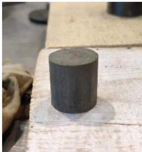
Рисунок 3.11 – Образец-цилиндр диаметром 20мм, изготовленный по технологии фильтрационного прессования
