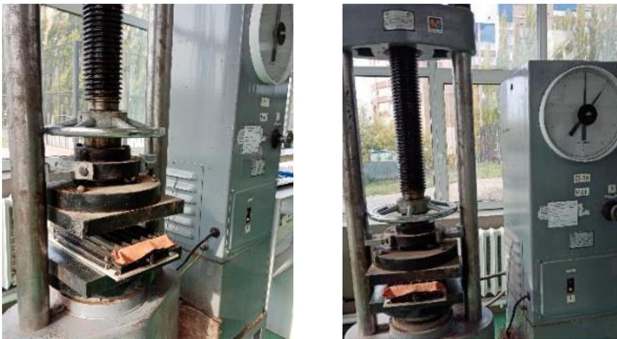
Рисунок 5.7 –Процесс фильтрационного прессования (начальный этап)
