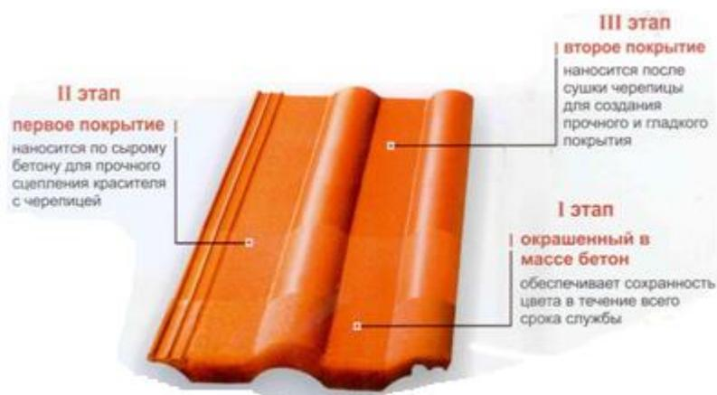
Рисунок 1.22 – Стандартная последовательность изготовления цементно-песчаной черепицы (согласно [30])
