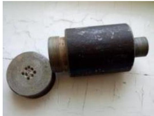
**Рисунок 3.8 – Внешний вид пресс-формы для изготовления цилиндрических образцов из цементно-песчаной смеси (в разобранном виде)**
