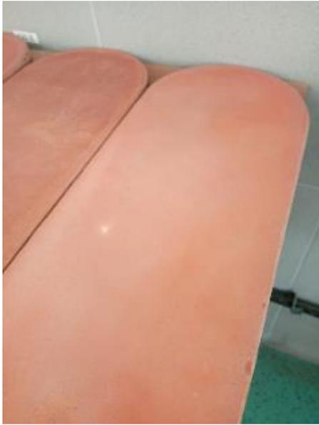
Рисунок 5.9 – Качество верхней (лицевой) поверхности цементно-песчаной черепицы, изготовленной по технологии фильтрационного прессования
