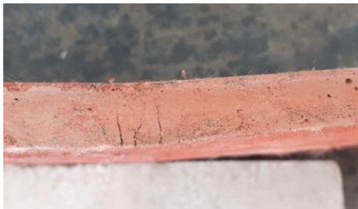
Рисунок 5.12 – Фрагмент образца черепицы с фиброй перед разрушением
