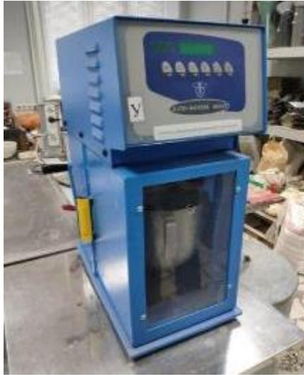
Рисунок 5.5 – Смеситель лабораторный принудительного для замешивания цементно-песчаной смеси AUTO MORTAR MIXER E093
