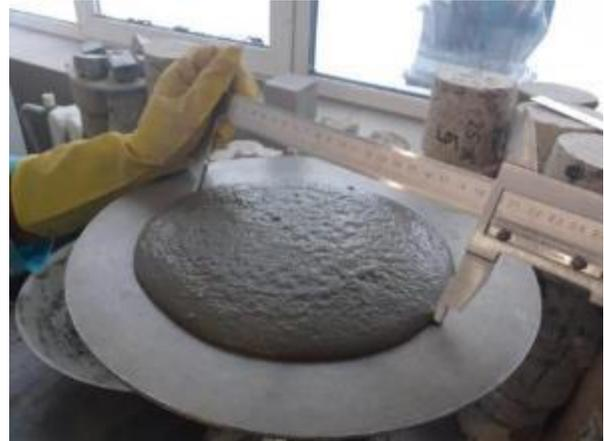
Рисунок 3.4 – Замеры расплыва конуса цементно-песчаной смеси состава №4 ( $R_k = 210\text{мм}$ )
