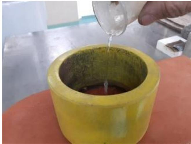
Рисунок 5.15 – Установка кольца на образец черепицы и заполнение его водой
