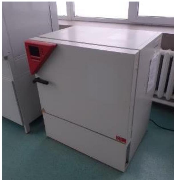
Рисунок 4.6 - Климатическая камера КВФ 115
