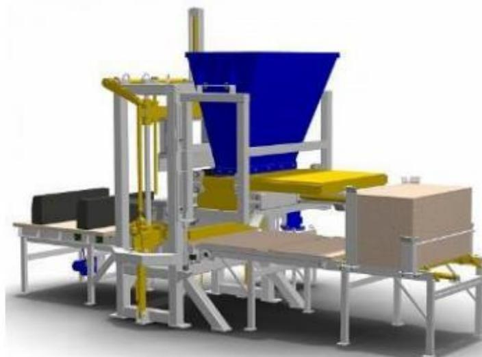
Рисунок 1.18 – Вибропресс производства ООО «Златоустовский вибропресс»
