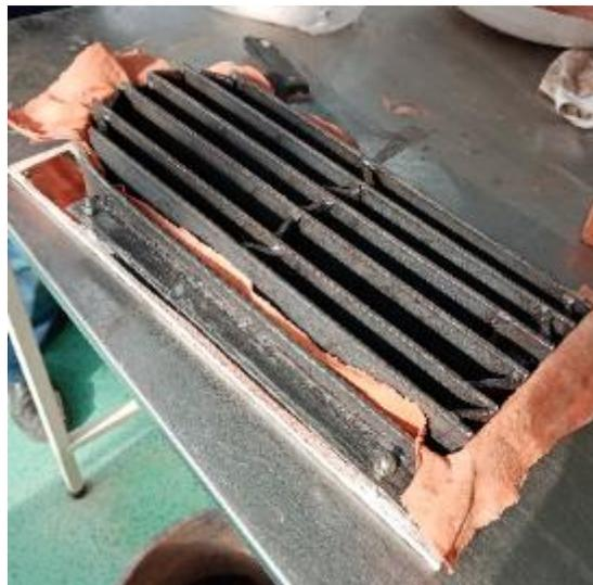
Рисунок 5.3 – Пресс-форма для изготовления цементно-песчаной черепицы в сборе
