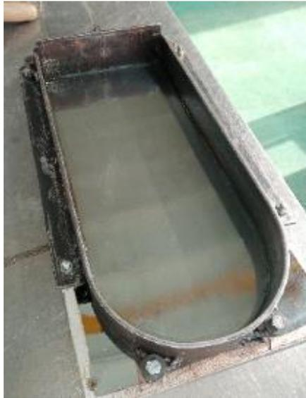
Рисунок 5.1 – Нижняя часть пресс-формы (матрица)
