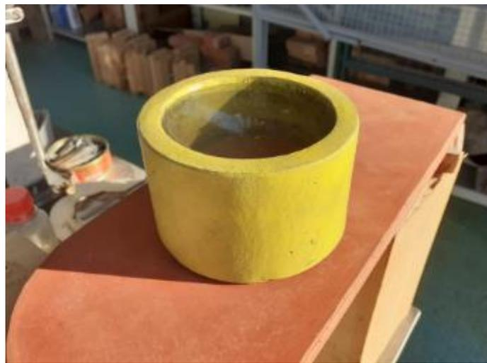
Рисунок 5.16 – Испытание цементно-песчаной черепицы на водонепроницаемость
