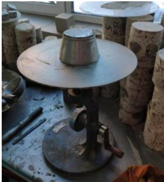
Рисунок 3.3 – Встряхивающий столик с конус-формой, заполненной цементно-песчаной смесью
