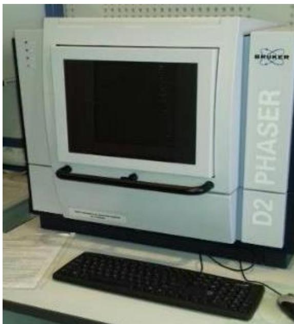
Рисунок 3.17 – Рентгеновский дифрактометр BRUKER D2 PHASER
