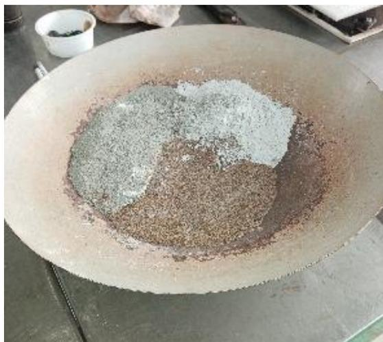
Рисунок 5.4 – Сухие компоненты, приготовленные к перемешиванию
