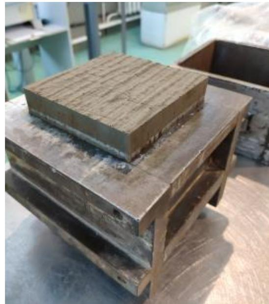
г – пластина после извлечения из пресс-формы (видна внутренняя поверхность изделия)
