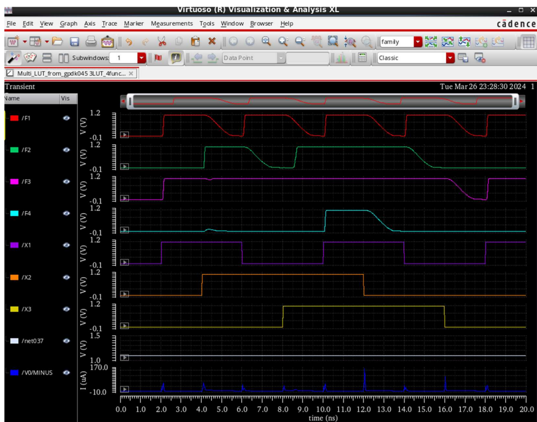
Рисунок ПБ 9г. – Результат моделирования 3-LUT, реализующего четыре функции одновременно
