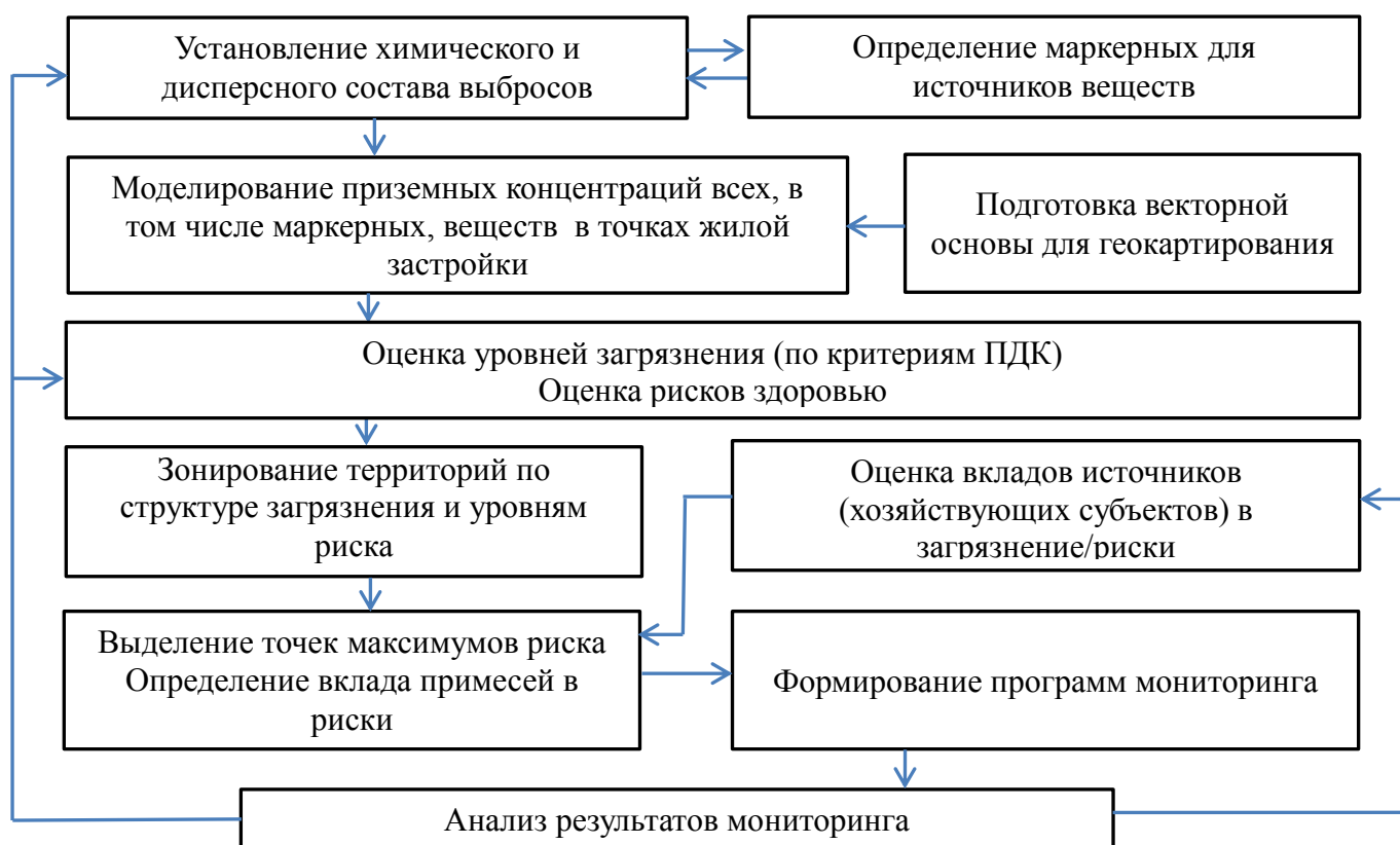
Рисунок 5.1 – Алгоритм определения точек мониторинга и контролируемых показателей
