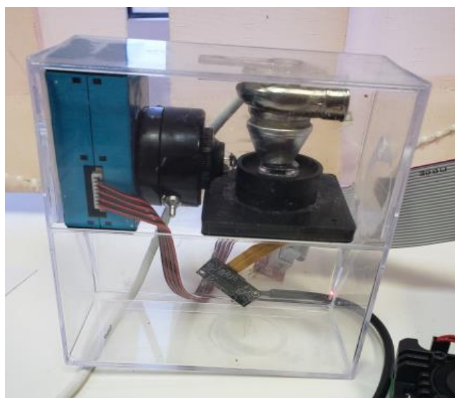
Рисунок 3.12 – Общий вид аппаратного комплекса распознавания пылевых частиц
