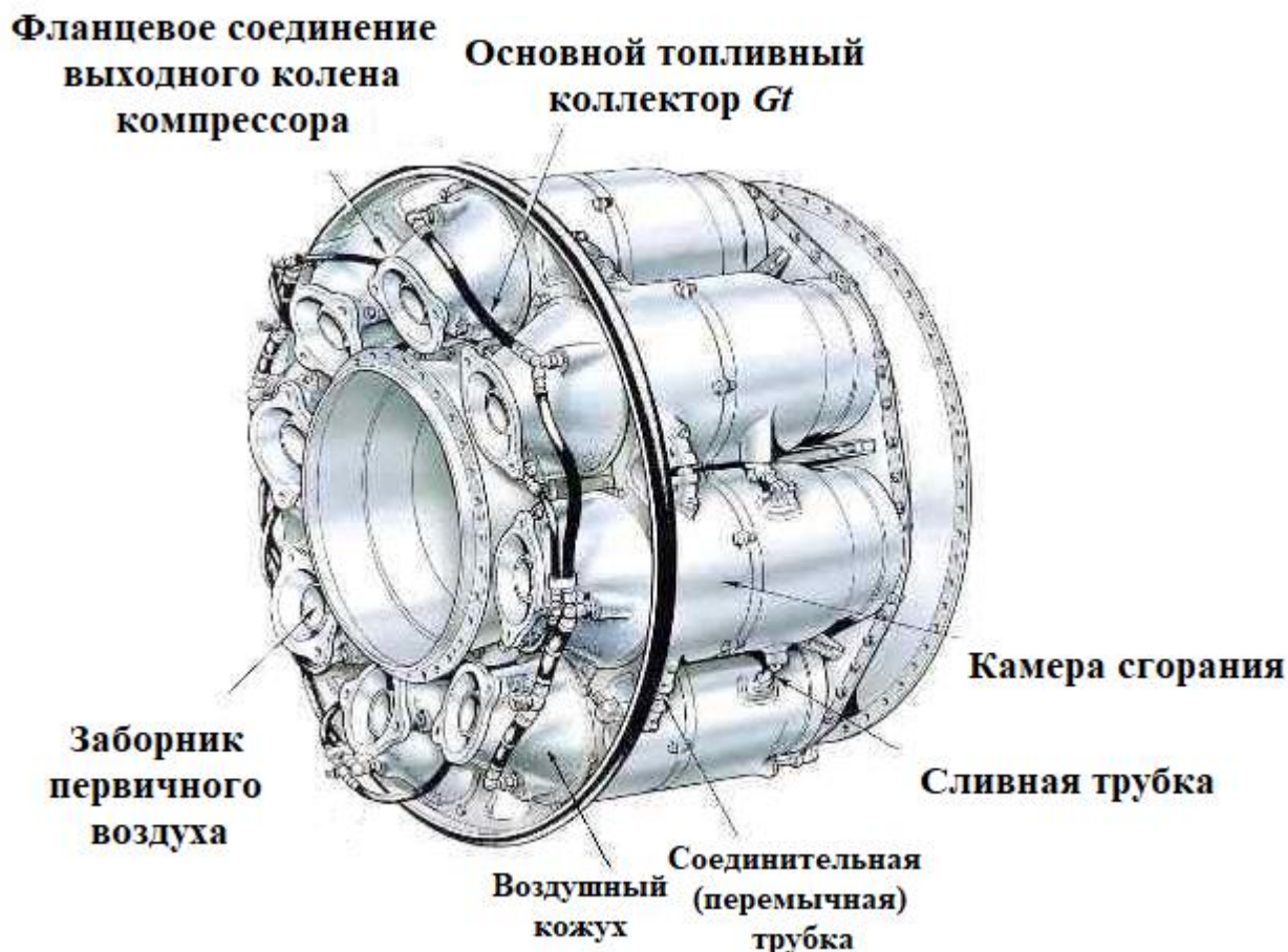
Рисунок 1.2 – Структура кольцевой малоэмиссионной камеры сгорания ГТД
