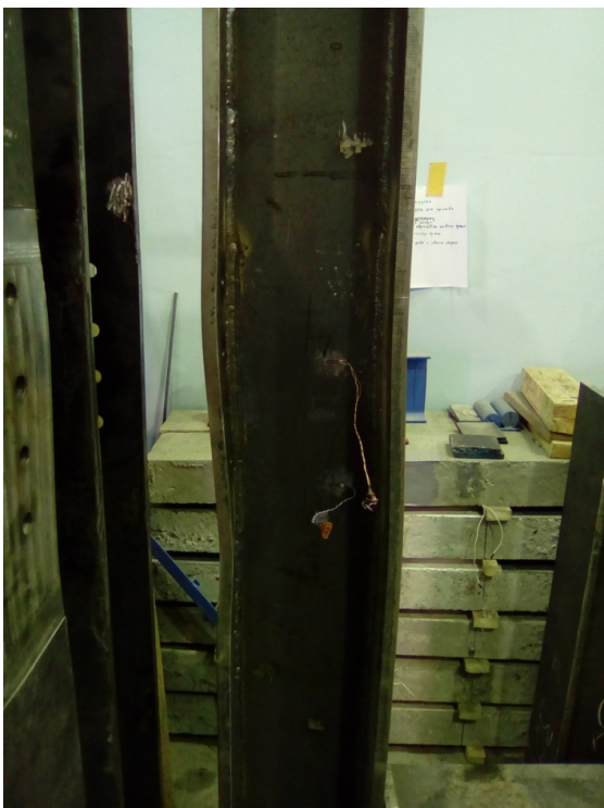
Рисунок 2.11. – Изгиб колонны, разрыв болта нижнего ряда, раскрытие фланцевого соединения
