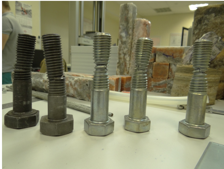
Рисунок 2.15. – Различные типы разрыва болтов
