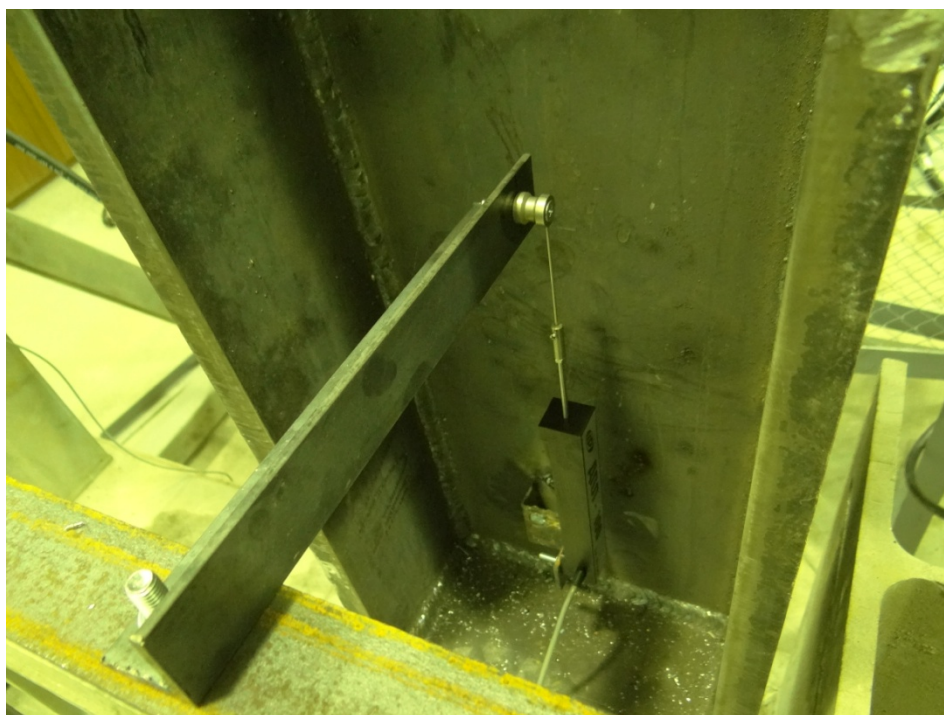
Рисунок 2.7. – Крепление центрального датчика перемещения центра колонны
