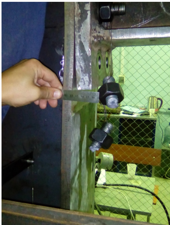
Рисунок 2.11. – Изгиб колонны, разрыв болта нижнего ряда, раскрытие фланцевого соединения
