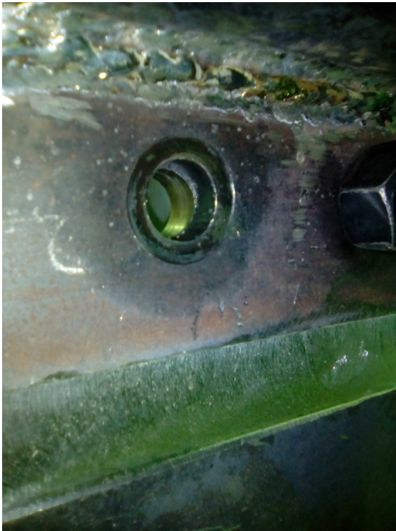
Рисунок 2.10. – Местное смятие околоболтовой зоны, разрыв болта нижнего ряда, раскрытие фланцевого соединения
