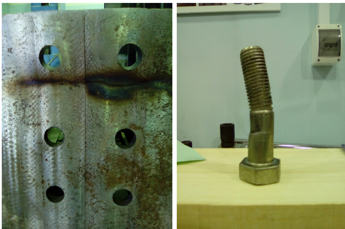
Рисунок 2.13. – Трещина фланца, Изгиб болтов после испытаний
