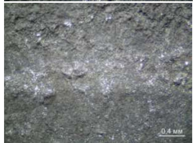
Рисунок 5.12 – Макрофрактограммы поверхности после коррозионных испытаний, горизонтальное сечение образцов, наплавленных плазма-МИГ наплавкой: а – сплошная коррозия с неравномерным характером поражения; б – избирательная коррозия с поражения в виде пятен; в – избирательная коррозия с элементами межкристаллитной
