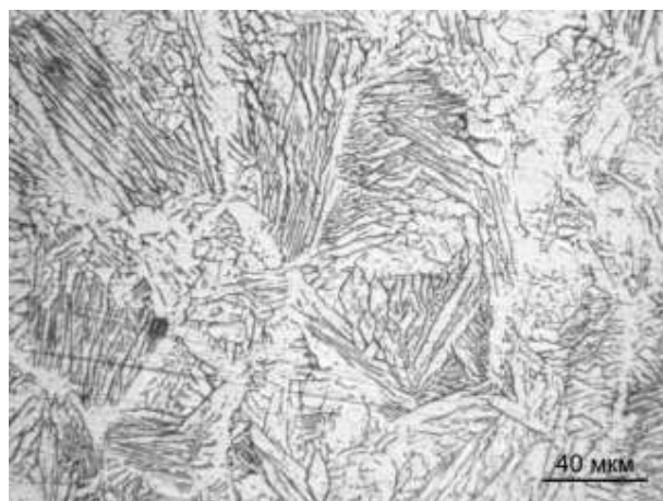
Рисунок 3.4 – Микроструктура одиночных валиков: а – непрерывная наплавка, б – частота 10000 Гц, увеличение \times 500
