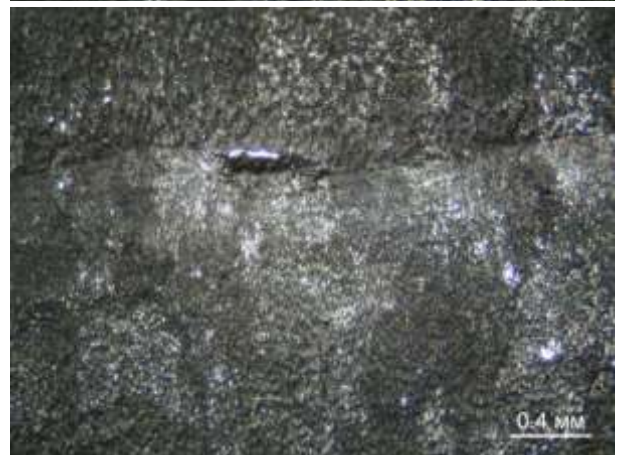
Рисунок 5.11 – Макрофрактограммы поверхности после коррозионных испытаний, продольное сечение наплавленных образцов:
