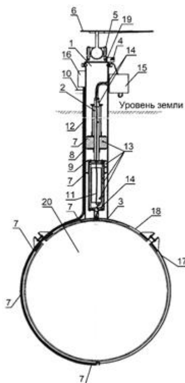
Рисунок 3.4 - Конструкция автоматизированного мониторинга подземного трубопровода ПАО «Транснефть»
