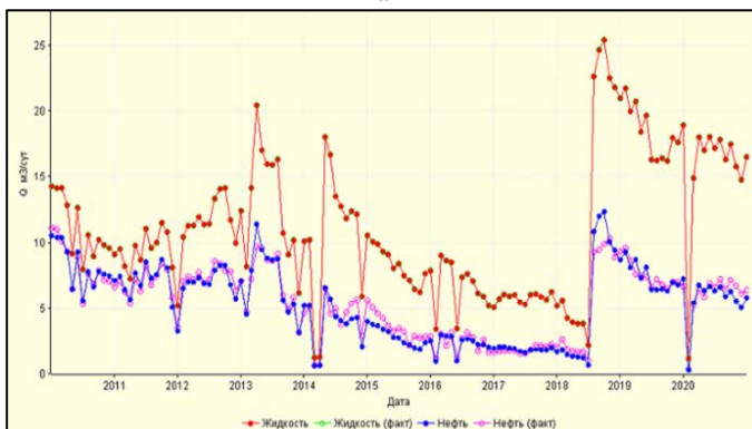
Рисунок 9 – Пример прогнозирования соляно-кислотной обработки (СКО) с отклонителем до и после настройки гидродинамической модели по предлагаемой методике. Скважина № 544, башкирская залежь Уньвинского месторождения: а – по старой методике; б – по разработанной методике)
