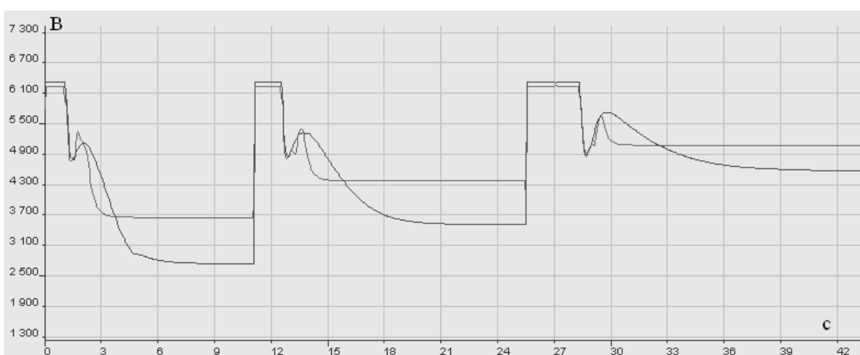
Рисунок 3.32 – Изменение действующего напряжения СГ в обучающей выборке (темная – экспериментальная, светлая – модельная)
