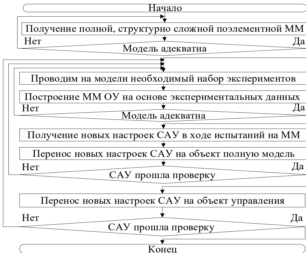
Рисунок 2.11 – Модернизированный алгоритм автоматизированной настройки САУ ГТУ в ходе испытаний
