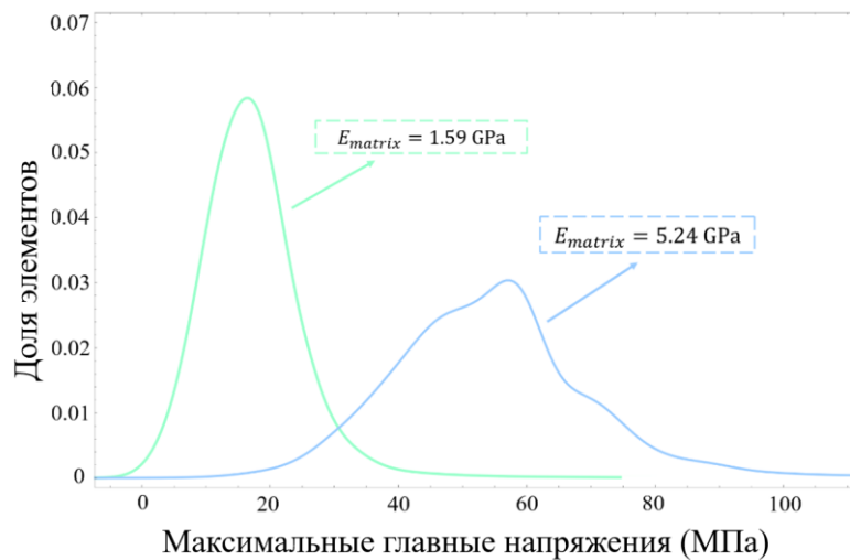
Рисунок 5.21 – Распределение максимальных главных напряжений в модели АБС+УВ с различными свойствами матрицы
