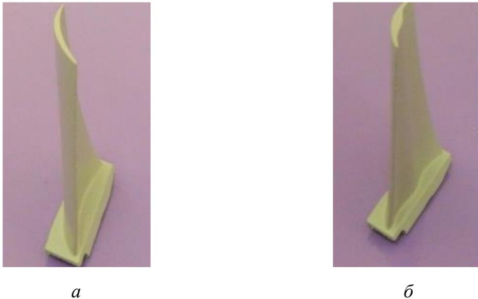
Рисунок 1.4 – Лопатка с классическим профилем пера (*а*) и лопатка с профилем Шварова (*б*)
