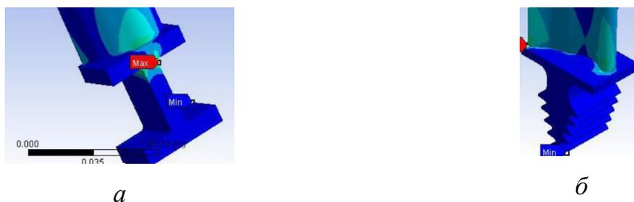
Рисунок 1.8 – Геометрия лопатки: (а) – с одной секцией замка; (б) – с замком елочного типа
