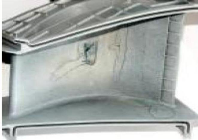
Рисунок 1.2 – Внешний вид поврежденной лопатки
