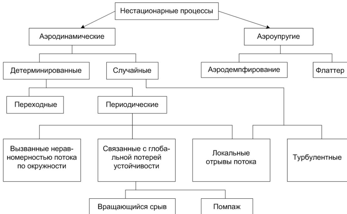
Рисунок 3.1 – Классификация нестационарных процессов в турбомашинах
