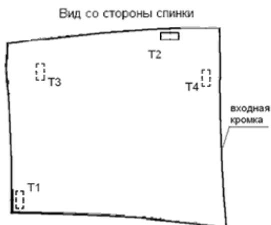
Рисунок 3.6 – Схемы препарирования пера рабочей лопатки КВД исходной конструкции
