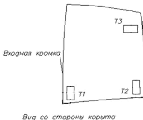
Рисунок 3.11 – Схемы препарирования лопаток КВД измененной конструкции
