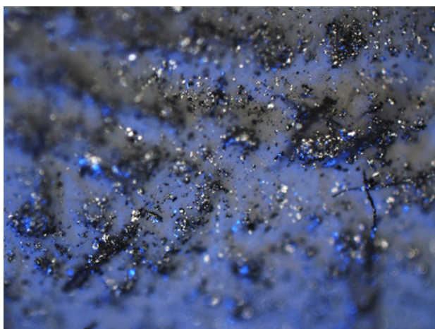
Рисунок 42 – Цилиндрическая поверхность образца с пропиткой без обжига
