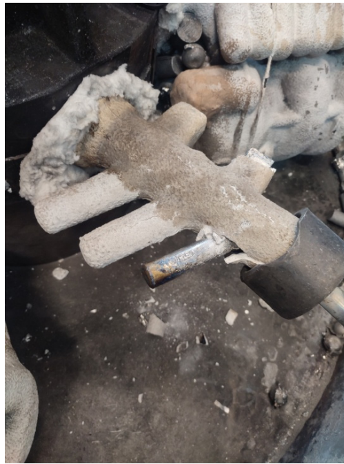
Рисунок 52 – Керамическая форма после заливки сплава BT5Л на центробежной установке
