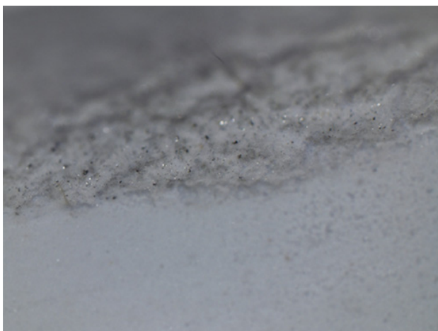
Рисунок 43 – Цилиндрическая поверхность образца с пропиткой и обжигом
