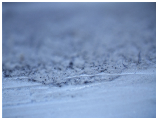
Рисунок 42 – Цилиндрическая поверхность образца с пропиткой без обжига
