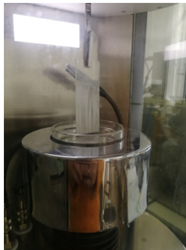
Рисунок 9 – Стекло́нная пласти́на, покры́тая полимером – связующим, подготовленная для проведения измерения угла смачивания
