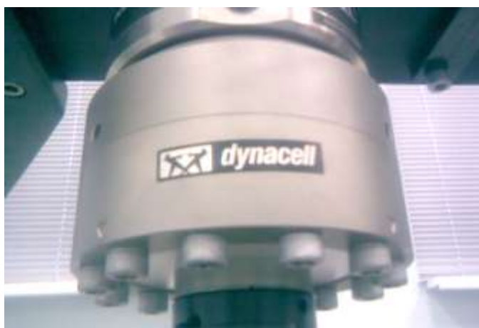
Рисунок 2.8 – Фотография датчика нагрузки Dynacell
