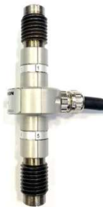
Рисунок 2.5 – Юстировочное устройство Alignment Cell
