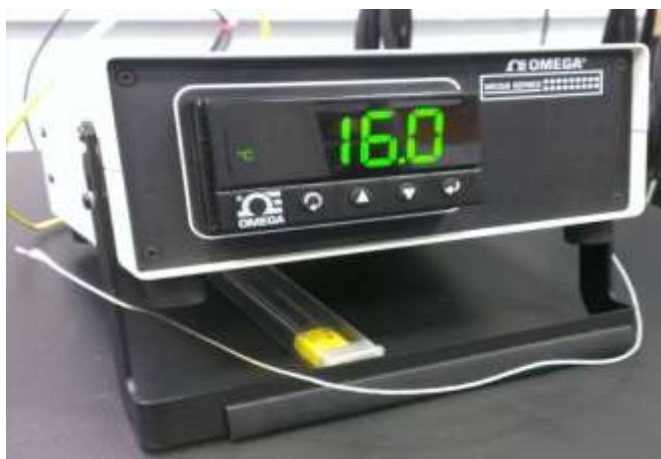
Рисунок 2.26 – Автономный монитор контроля температуры Omega MDSi8A
