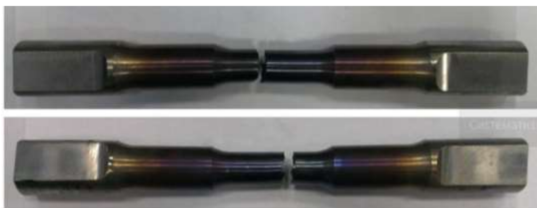
Рисунок 4.18. – Фотографии разрушенных образцов стали ЭП517Ш после испытаний на малоцикловую усталость при совместном растяжении с кручением при температуре 600°С
