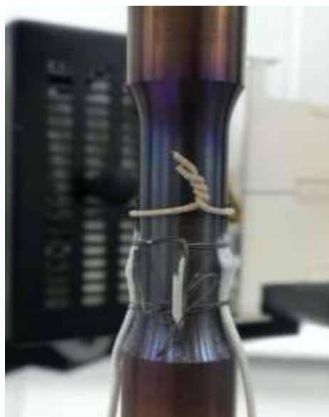
Рисунок 2.25 – Термопары, закрепленные к образцу в рабочей части
