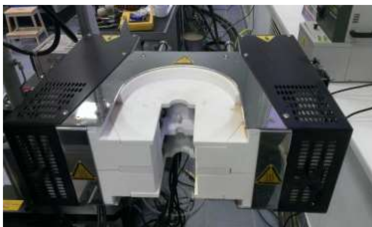
Рисунок 2.22 – Высокотемпературная печь Instron CP100409
