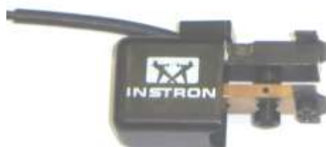
Рисунок 2.9 – Динамический экстензометр Instron 2620-603 для испытаний в условиях одноосного циклического деформирования
