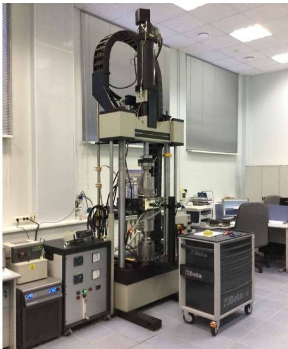
Рисунок 2.10 – Фотография универсальной двухосевой сервогидравлической испытательной системы Instron 8850
