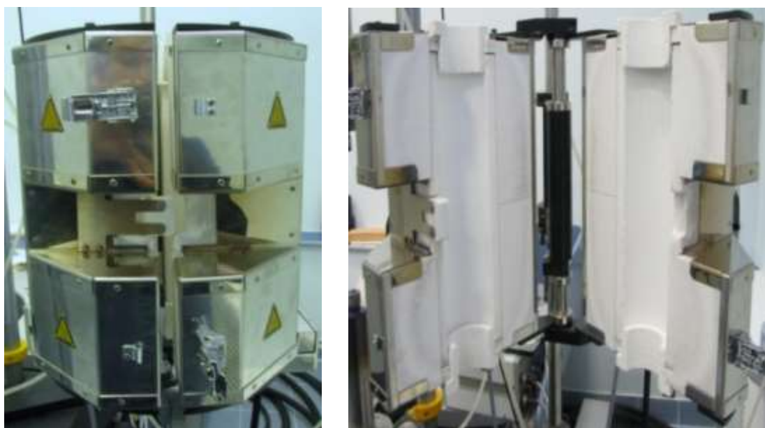
Рисунок 2.19 – Фотография высокотемпературной печи SF 1770 в открытом (а) и закрытом (б) положениях
