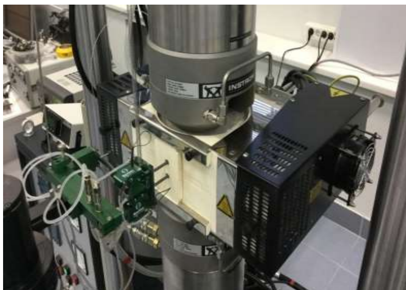
Рисунок 2.23 – Установленный двухосевой экстензометр Epsilon 3550HT-025M
