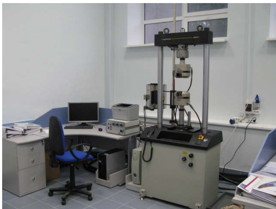
Рисунок 2.4 – Фотография сервогидравлической испытательной системы Instron 8801
