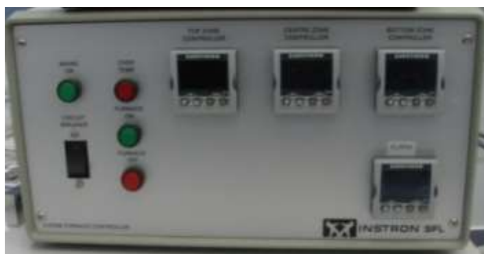
Рисунок 2.20 – Фотография трехзонного контроллера печи SFL
