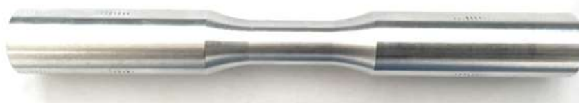
Рисунок 4.10 – Эскиз (а) и внешний вид (б) тонкостенного трубчатого образца
