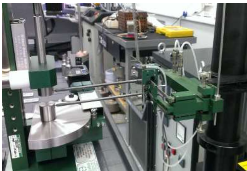
Рисунок 2.24 – Тестирование высокотемпературного экстензометра перед испытанием на двухосевом калибраторе Epsilon Calibrator Stand
