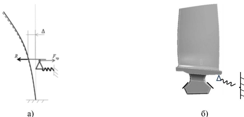
Рисунок 2.01 – а) Балочная модель с упругим демпфером,
