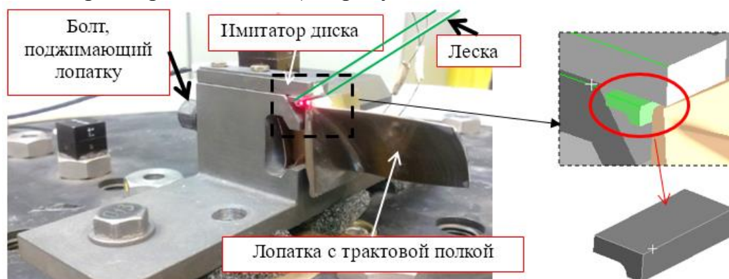
Рисунок 9 – Лопатка ГТД с модельным демпфером на вибростенде
