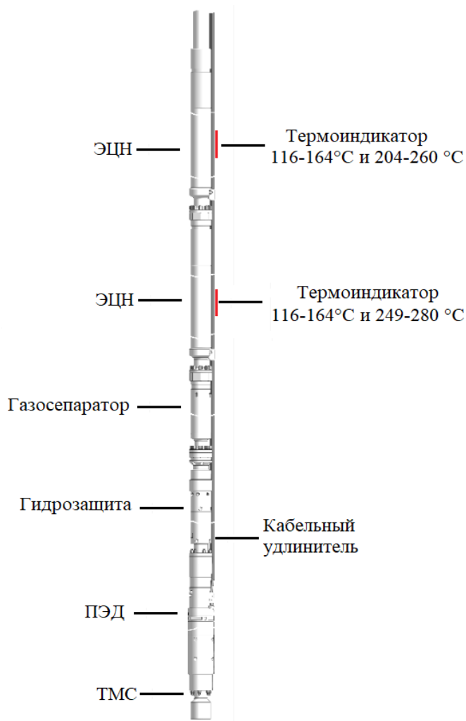
Рисунок 2 - Схематическое расположение термоиндикаторов на установке ЭЦН
