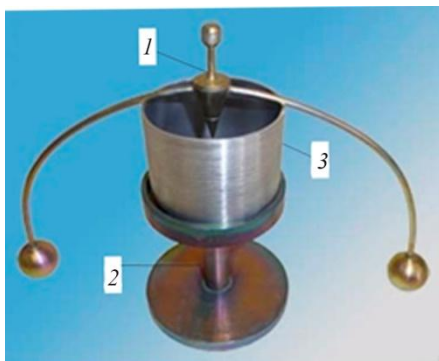
Рис. 55. Прибор Васильева: 1 – конус Васильева; 2 – подставка; 3 – чашка
