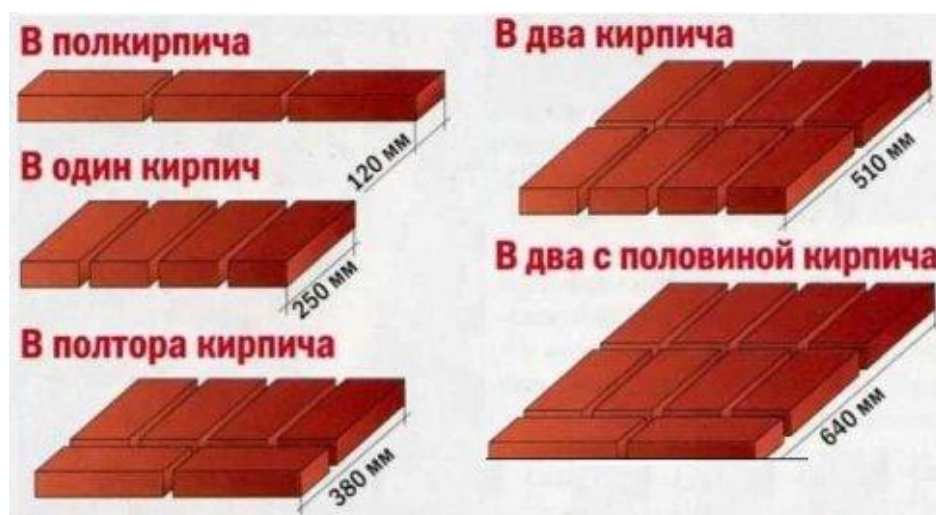
Рис. 3. Схемы кирпичных стен по толщине
