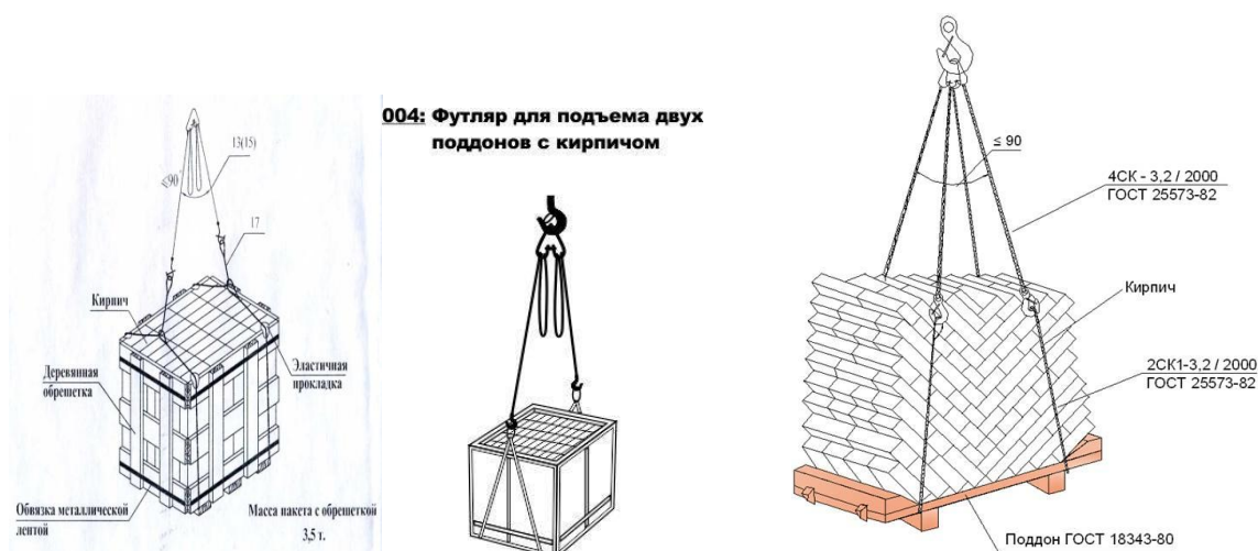
Рис. 48. Примеры использования стропов при подаче поддонов
