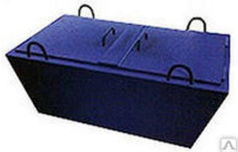
Рис. 44. Бункеры, предназначенные для подачи раствора на рабочее место каменщиков
