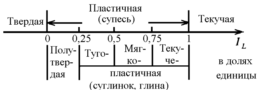
Рис. 2 Схема классификации глинистых грунтов в зависимости от показателя текучести
