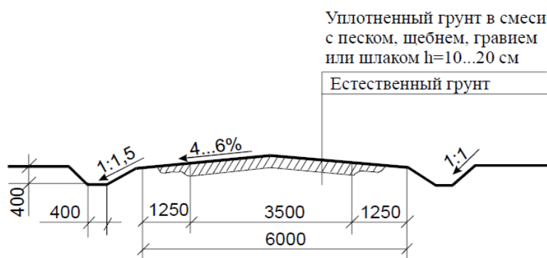
Рис. 2.6 Пример проектирования грунтовой внутрипостроечной дороги.
