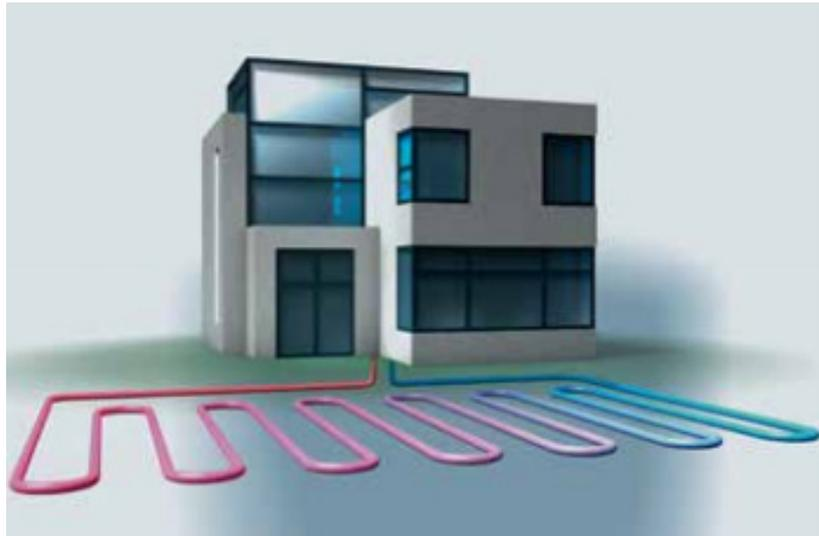
Рис. 3. Схема горизонтального грунтового теплообменника
