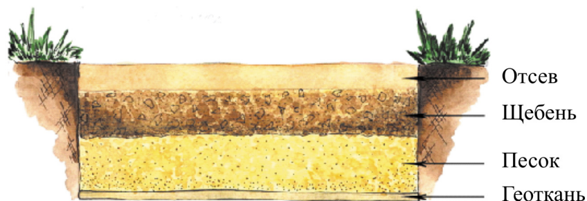
Рис. 24. Схема устройства дорожки из мульчи [1]
