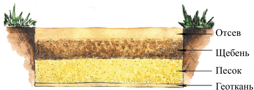
Рис. 23. Схема устройства гравийной дорожки [1]
