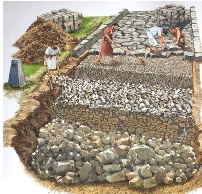
Рис. 5.51. Конструкция римских дорог
