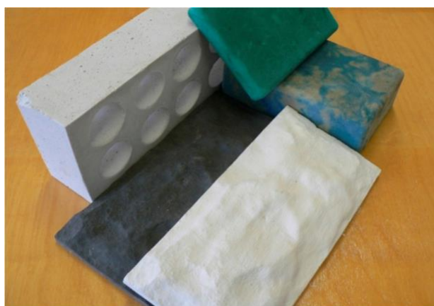
Рис. 3.4. Фото изделий, полученных из отходов стекла заливкой в формы композиции из ионно-модифицированного дисперсного стекла раствора жидкого стекла с пигментами
