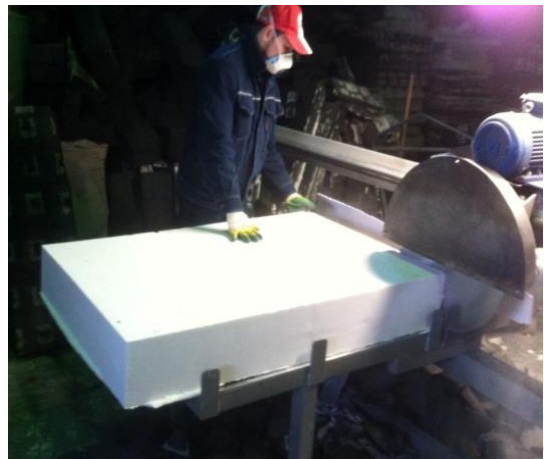
Рисунок 5.7. Процесс изготовления ячеистых стеклокристаллических плит: а) плиты после термообработки в колпаковых печах; б) калибровка плиты
