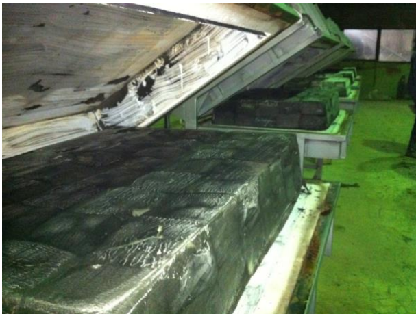
Рисунок 5.7. Процесс изготовления ячеистых стеклокристаллических плит: а) плиты после термообработки в колпаковых печах; б) калибровка плиты
