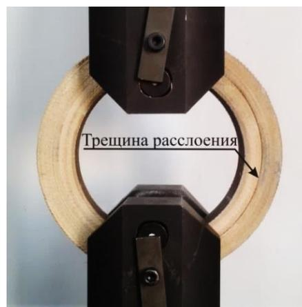
Рисунок 10 – Испытания втулки на расслоение при растяжении
