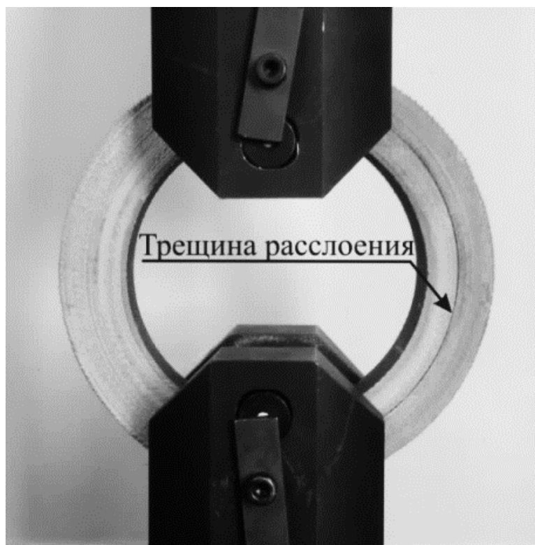
Рисунок 2.14 – Испытания втулки на расслоение при растяжении
