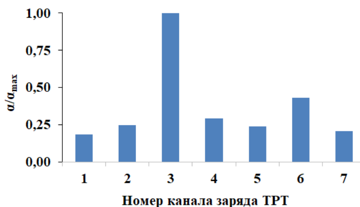
Рис. 4.72: Сравнение безразмерного коэффициента теплоотдачи для различных каналов массоподвода, где: 1 – шестилучевое сечение; 2 – двенадцатилучевое сечение; 3 – шестилучевое звездчатое сечение; 4 – трехлопастное сечение; 5 – четырехлопастное сечение; 6 – пилообразный канал; 7 – канал с проточкой
