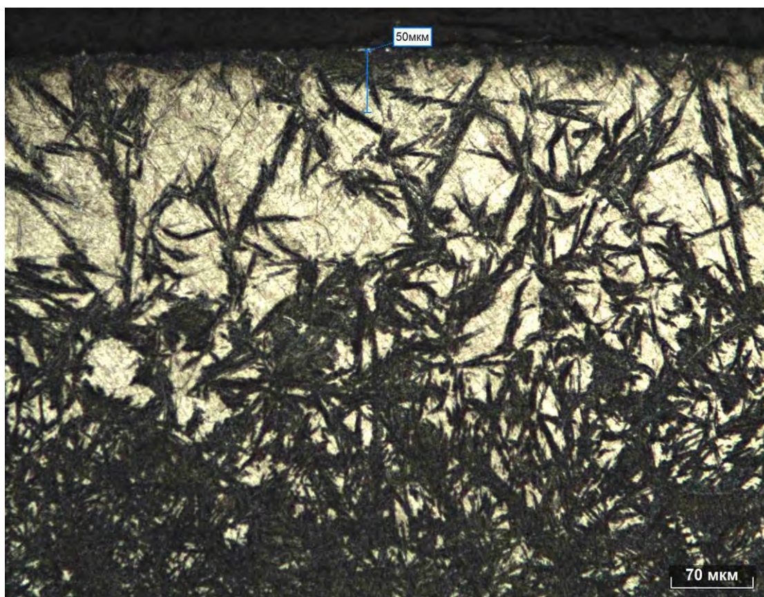
Рисунок 6.8 - Микроструктура цементованного слоя стали 12X2H4A после цементации и высокого отпуска.
