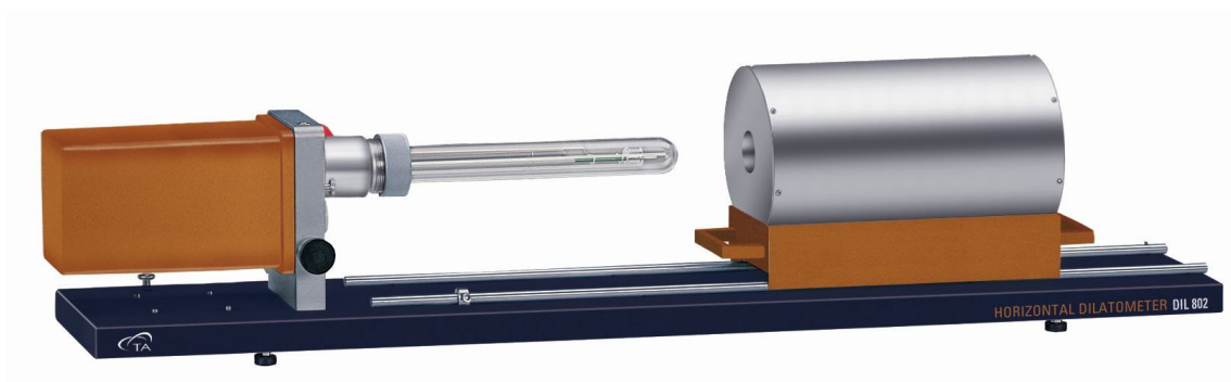
Рис. 2.8. Горизонтальный дилатометр DIL 802
