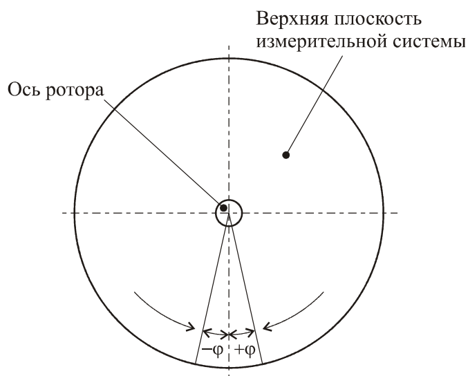
Рис. 2.11. Схема динамических испытаний реометра Discovery HR-2
