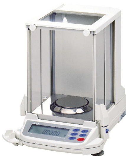
Рис. 2.7. Аналитические весы AND GR-200
