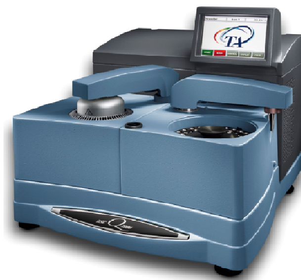
Рис. 2.3. Внешний вид прибора DSC Q2000
