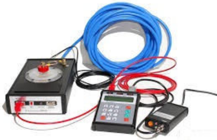
Рис. 2.18. Мост переменного тока высоковольтный МЭП-5СА
