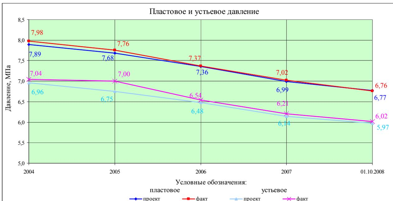
Рисунок 5.4 – Динамика изменения пластового давления
