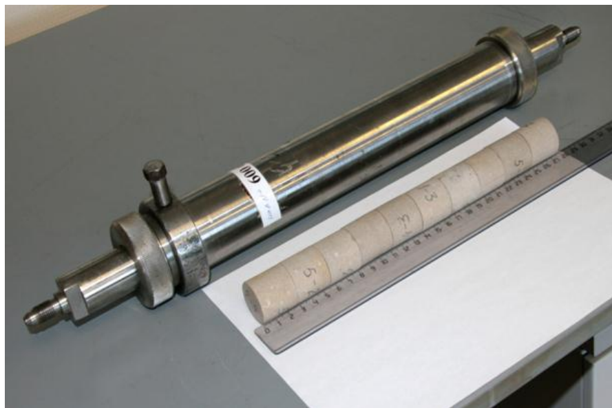
Рисунок 1.3.2 – Составная модель пласта и кернодержатель высокого давления
