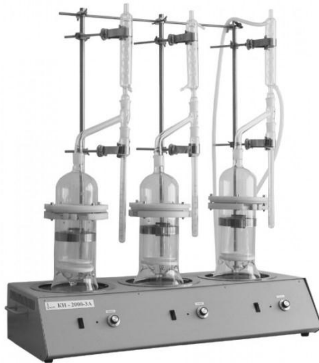
Рисунок 1.3.4 – Аппараты Закса (ЛП-4) для больших образцов керна в групповом колбонагревателе
