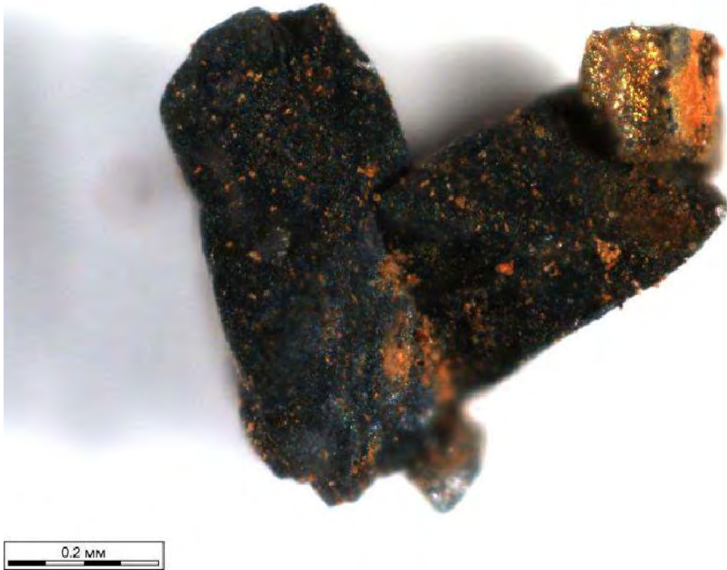
Рисунок 2-2 – Срастание зерен кальцита и пирита в отложениях дренажной системы земляной плотины [Максимович, Хмурчик, 2013]
