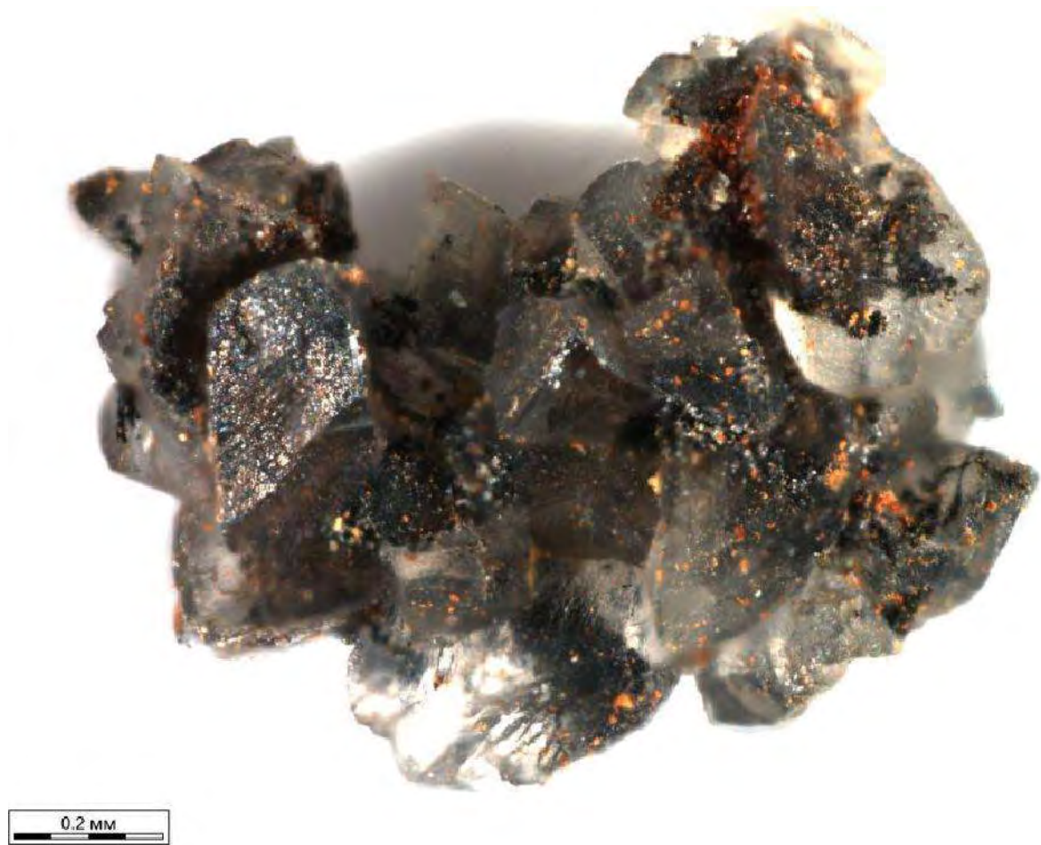
Рисунок 2-1 – Агрегат прозрачных зерен кальцита в отложениях дренажной системы земляной плотины [Максимович, Хмурчик, 2013]
