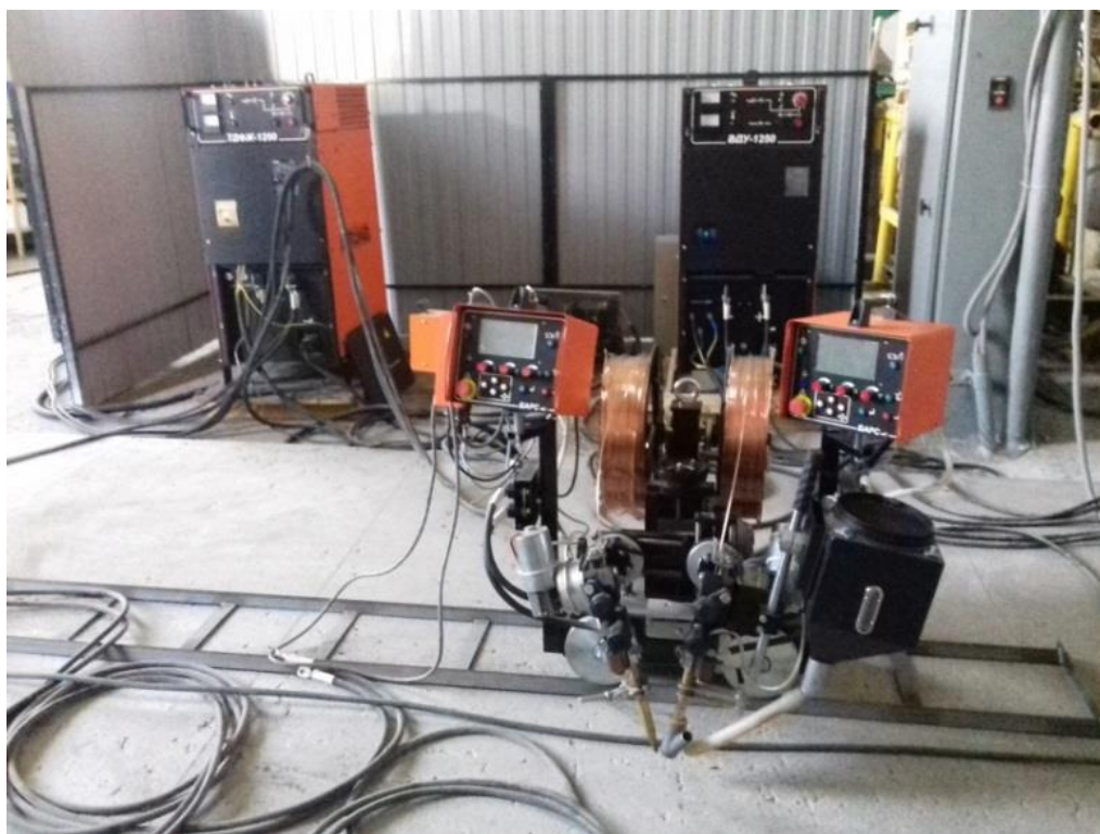
Рисунок 2.9 – Установка автоматической двухдуговой сварки АДФ 2500 Тандем
