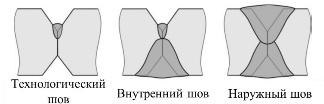
Рисунок 1.1 – Последовательность выполнения сварных швов при производстве электросварных труб большого диаметра
