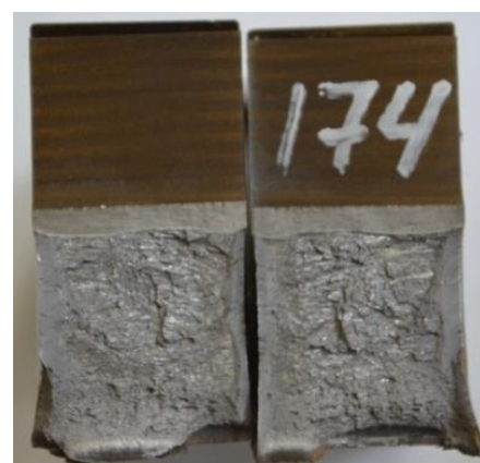
Рисунок 2.1 – Хрупкое разрушение металла сварного шва при испытаниях на статическую трещиностойкость: а) диаграмма «нагрузка – раскрытие надреза»; б) внешний вид поверхности излома
