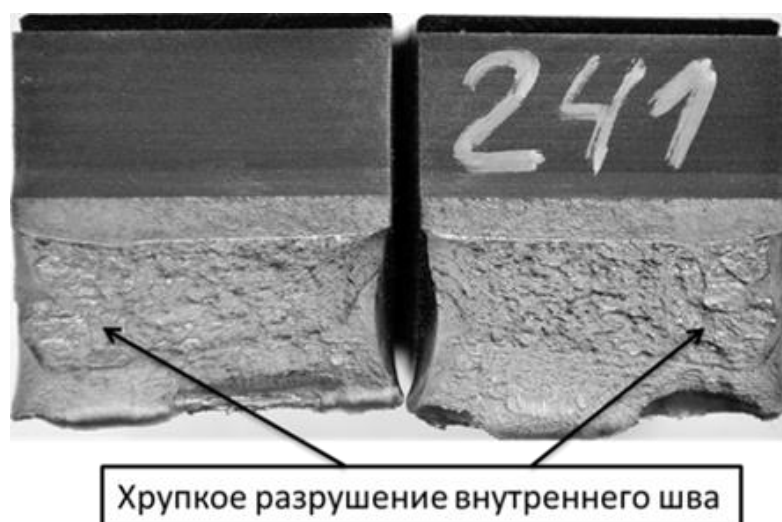
Рисунок 2.2 – Хрупкое разрушение внутреннего шва при сварке с сочетанием проволок №5
