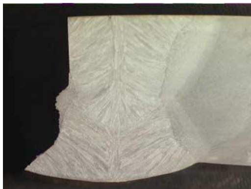
Рисунок 1.5 – Макрошлиф области разрушения сварного соединения ТБД при гидравлических испытаниях [52]
