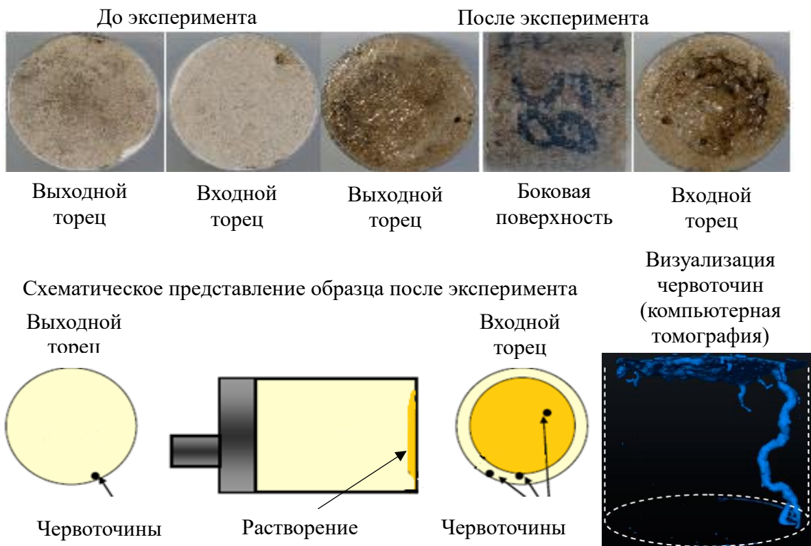
Рисунок 4.3.3 Пример результатов эксперимента по оценке влияния скорости закачки 15%-ного раствора соляной кислоты на эффективность кислотного воздействия (образец №58, расход 0.2 см 3 /мин)
