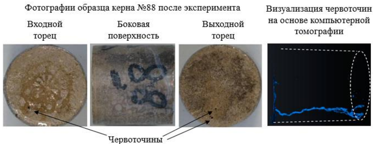
Рисунок 4.3.1 Пример результатов эксперимента по оценке влияния концентрации кислоты на развитие «червоточин» (образец № 88, концентрация кислоты - 5%)
