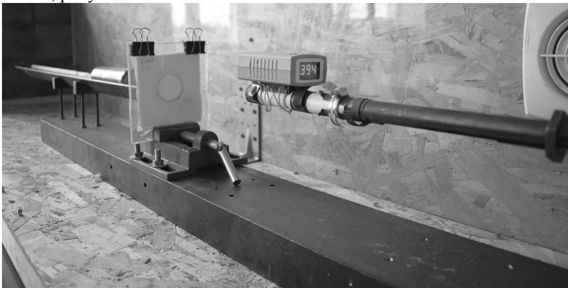
Рис. 10. Баллистический стенд с закрепленным образцом в захвате
