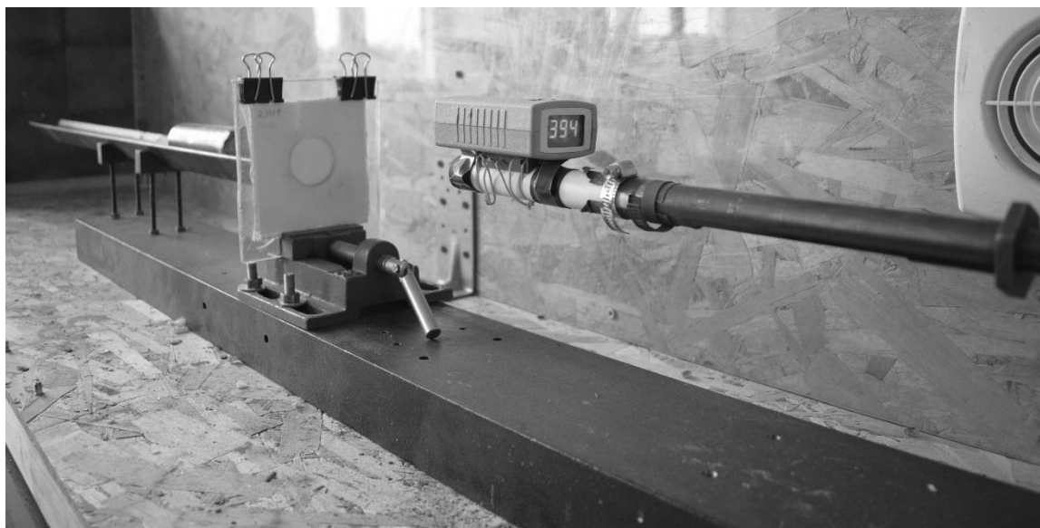
Рисунок 5.3. Баллистический стенд с закрепленным образцом в захвате
