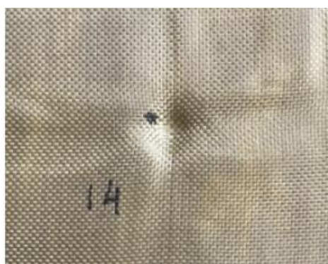
Рисунок 3.10. Характер деформирования двух слоев ткани P110 с термопластом ПВА и технического пластилина после удара со скоростью 108 м/с
