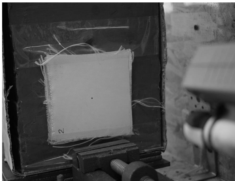
Рисунок 5.9. Общий вид закрепления образца на разгонном стенде
