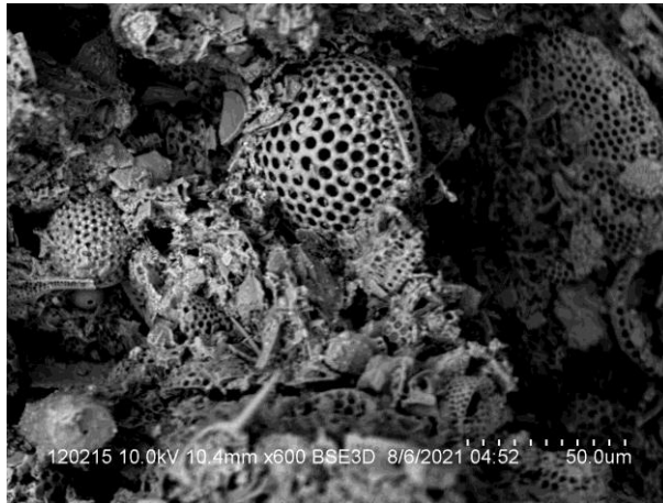
Рис. 3.7. Фотография скола центральной части гранулы, изготовленной из сернисто-щелочного отхода, адсорбированного трепелом с последующей термообработкой при 700°C
