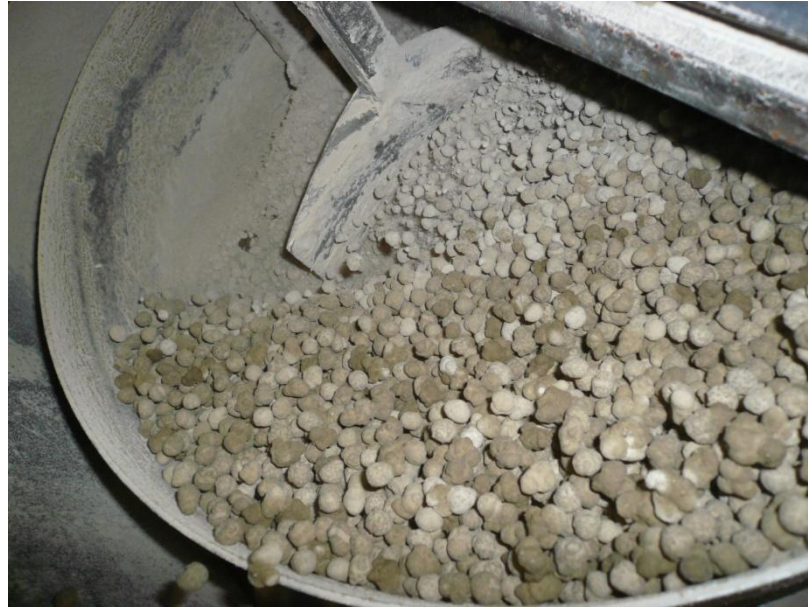
Рис. 5.2. Получение сырцовых гранул в тарельчатом грануляторе из сернисто-щелочных отходов и трепела
