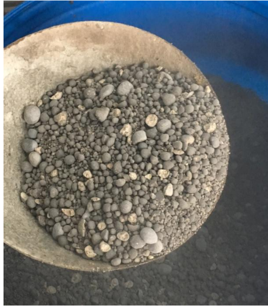
Рис. 5.4. Полученный после обжига тяжелый гранулированный материал
