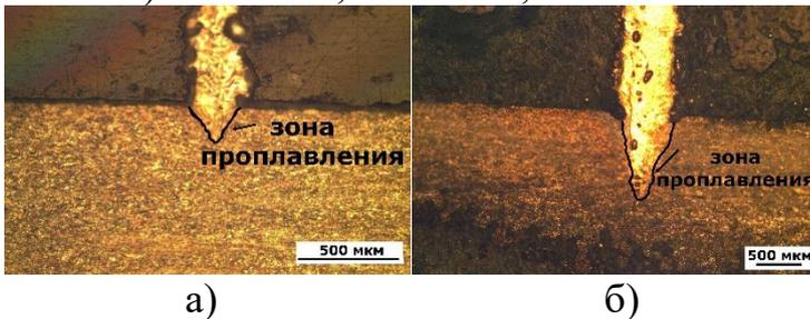
Рисунок 6 – Глубина проплавления при:
