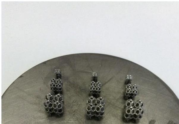
Рисунок 3.32 – Ячеистые структуры, полученные методом СЛП
