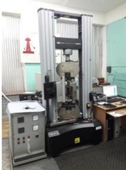
Рисунок 2.2 – Универсальная напольная электромеханическая испытательная машина Instron 5885Н
