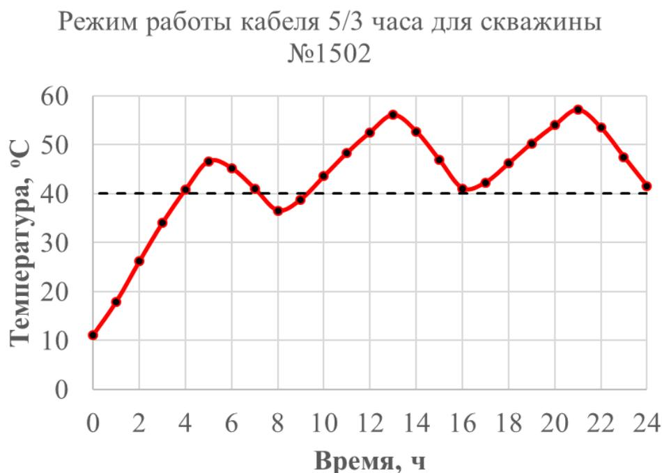
Рисунок 4.12 – Распределение температуры на устье скважины при режиме работы греющего кабеля 5/3
