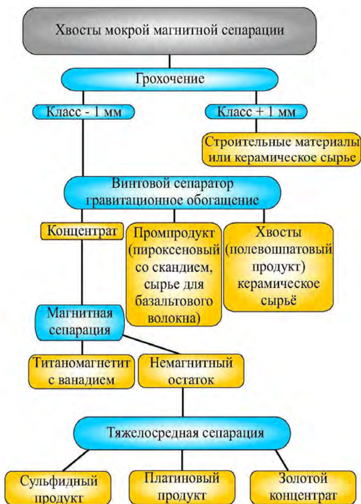
Рис.8. Технологическая схема переработки хвостов мокрой магнитной сепарации Качканарского ГОКа
