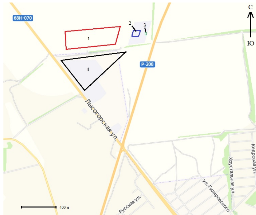
Рисунок 2.2 – Полигон ТКО ООО «КомЭк»: 1 – зона складирования ТКО; 2 – сортировочный цех; 3 – административная часть; 4 – закрытая городская свалка ТКО
