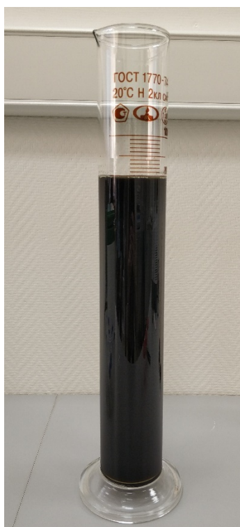
Рисунок 5.1 – Фильтрат полигона ТКО
