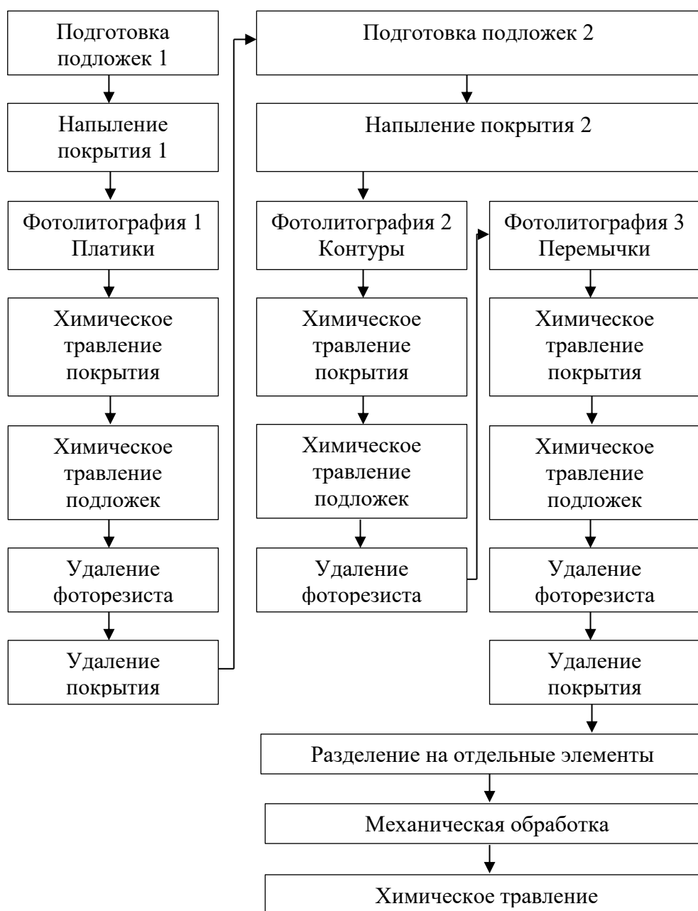
Рисунок 4.3 – Оригинальная блок-схема изготовления чувствительного элемента из кварцевого стекла
