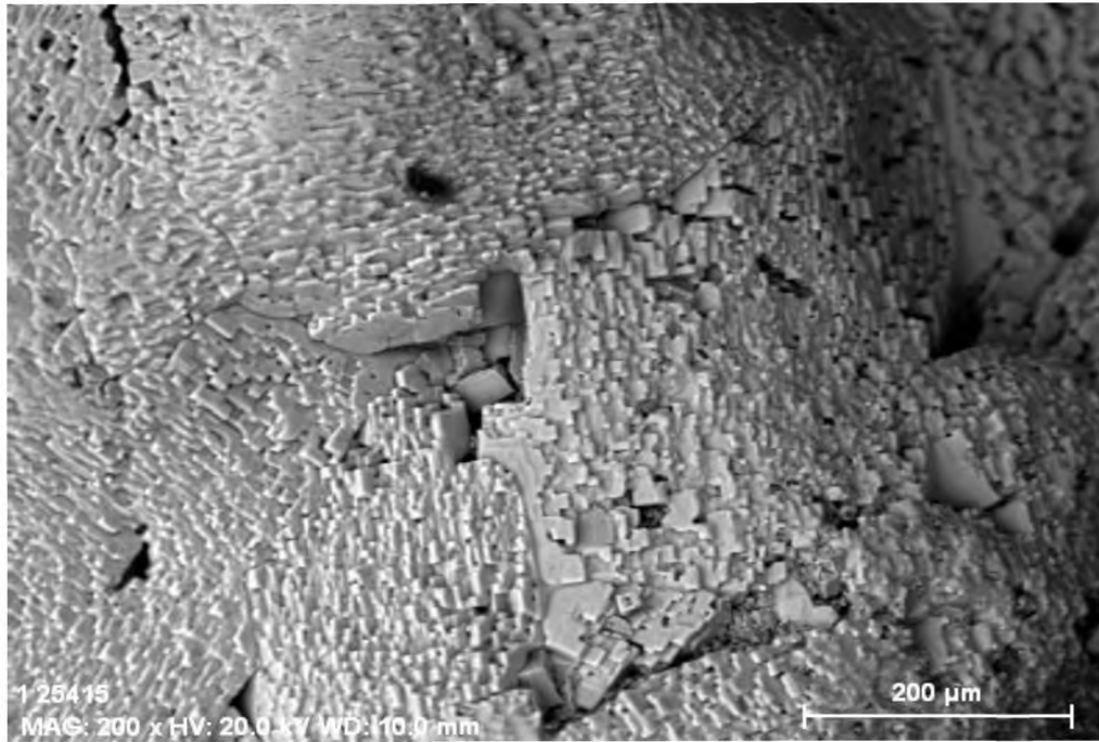
Рисунок 4.6 – Микрофотография образца галургических галитовых отходов после ультразвуковой обработки, \times 200
