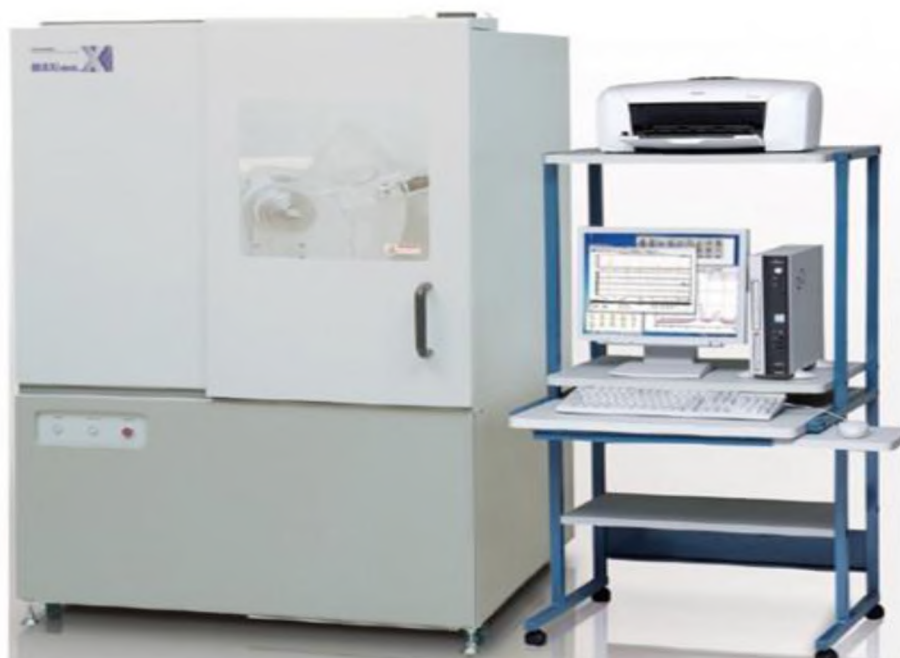
Рисунок 2.2 - Порошковый рентгеновский дифрактометр XRD-7000S, Shimadzu Corporation, Япония
