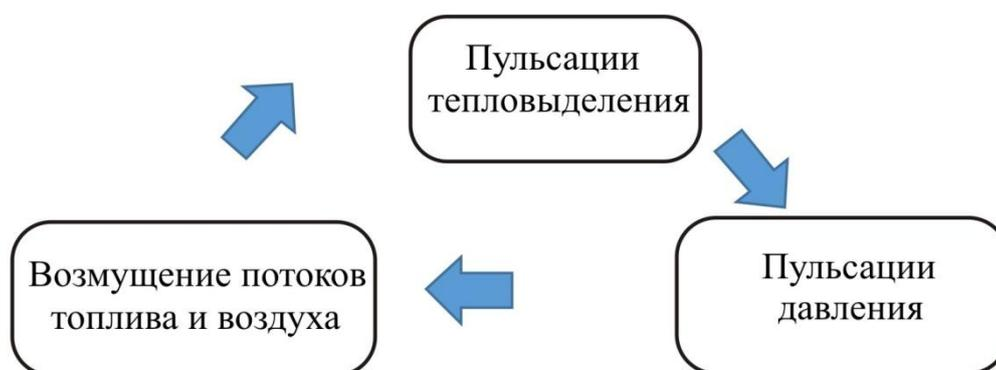
Рисунок 3.2 – Схема механизма обратной связи
