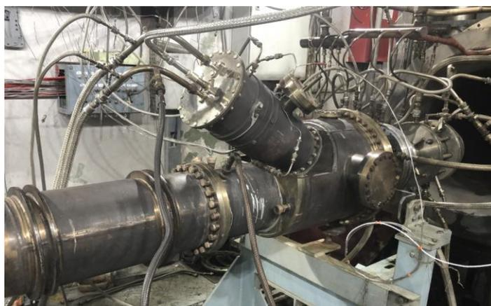
Рисунок 2.6 – Одномодульная МЭКС в составе одногорелочного отсека
