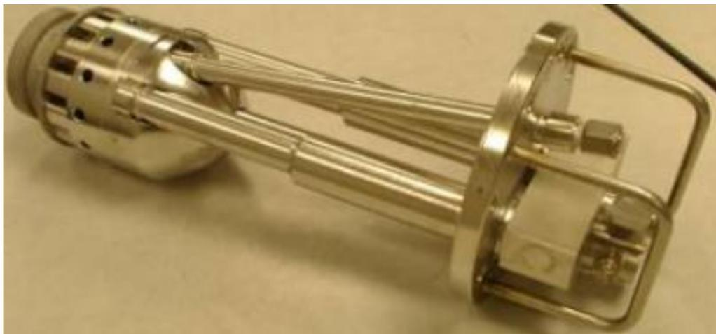
Рисунок 1.38 – Топливный смеситель Titan 250 [39]
