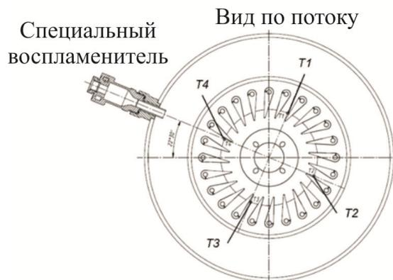
Рисунок 4.8 – Схема расположения специального воспламенителя и контрольных проскоковых термопар Т1...Т4
