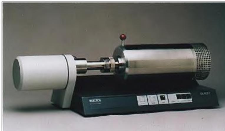
Рисунок 2.18 – Дилатометр DIL-402C
