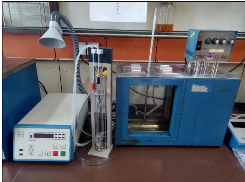
Рисунок 2.12 – Прибор для определения вязкости жидкостей с вискозиметром
