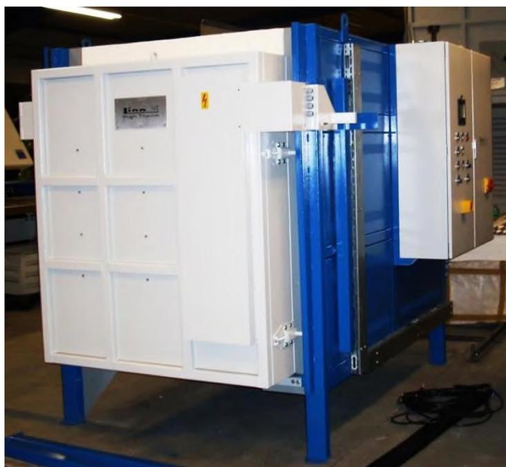
Рисунок 5.6 – Камерная электрическая печь фирмы «LINN»
