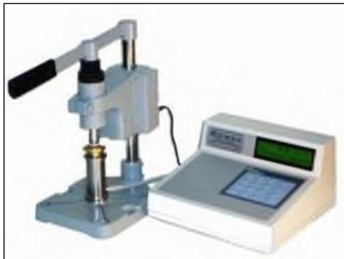
Рисунок 2.4 – Прибор дисперсионного анализа ПСХ-11(SP)
