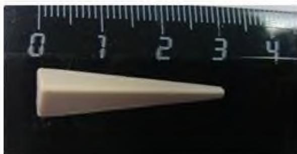
Рисунок 2.16 – Внешний вид образца для определения огнеупорности литейной керамики
