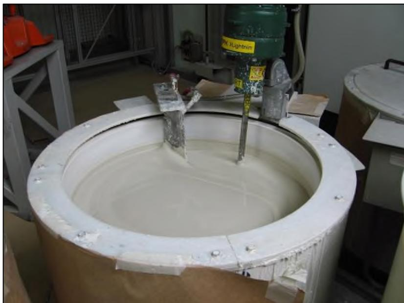
Рисунок 5.2 – Резервуар с перемешивающим устройством
