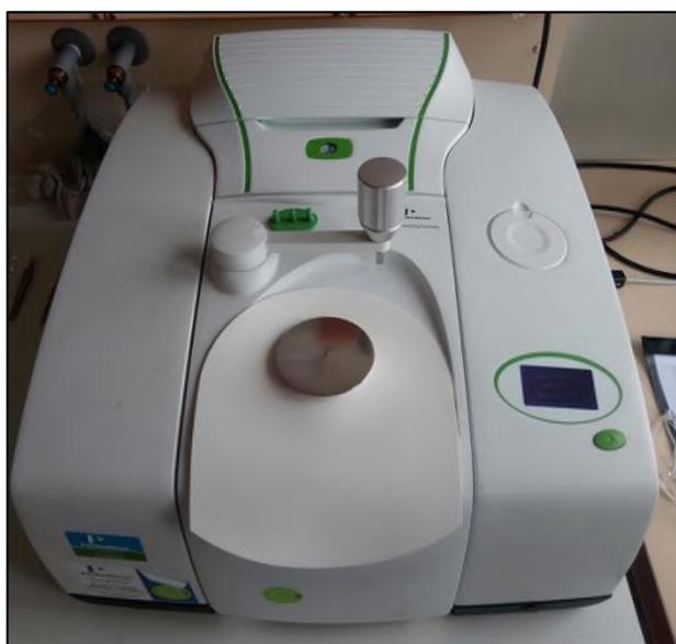
Рисунок 2.8 – НПВО спектрометр Frontier MIR/FIR
