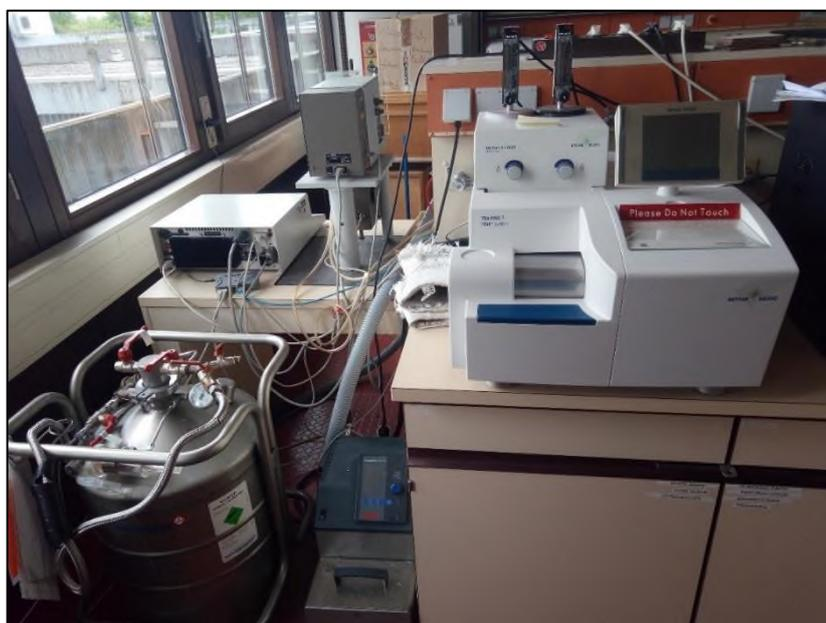
Рисунок 2.10 – Термоанализатор TGA/DSC 1 STAR System
