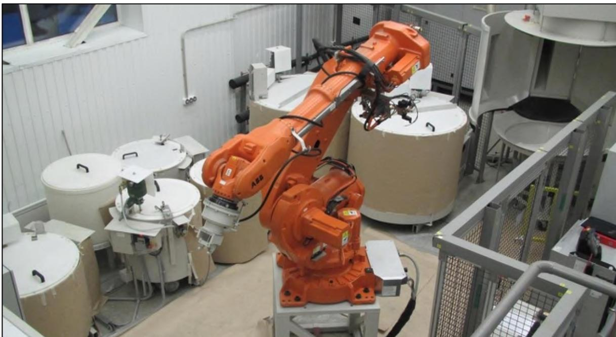
Рисунок 5.3 – Автоматизированный комплекс для нанесения керамических суспензий и обсыпки огнеупорными порошками
