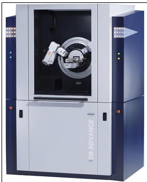
Рисунок 2.6 – Рентгеновский дифрактометр Bruker D8 ADVANCE
