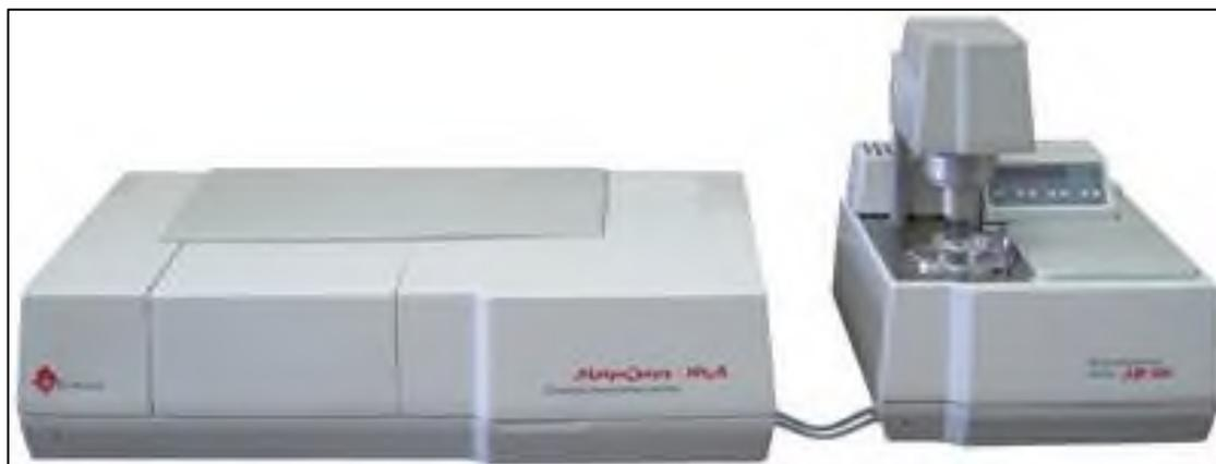
Рисунок 2.3 – Лазерный дифракционный анализатор частиц Микросайзер 201С
