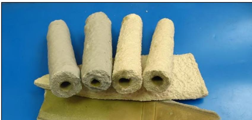
Рисунок 2.17 – Внешний вид образцов для определения открытой пористости и кажущейся плотности литейной керамики
