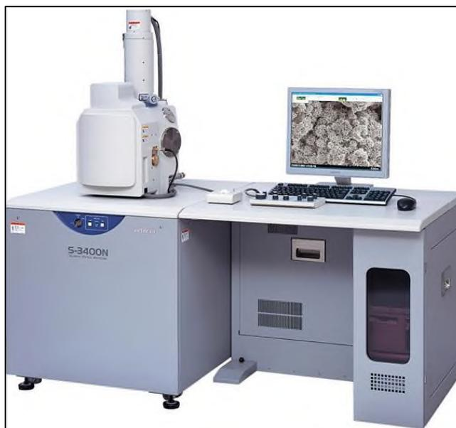
Рисунок 2.1 – Сканирующий электронный микроскоп высокого разрешения с рентгено-флуоресцентной приставкой S3400N «НИТАСНІ»
