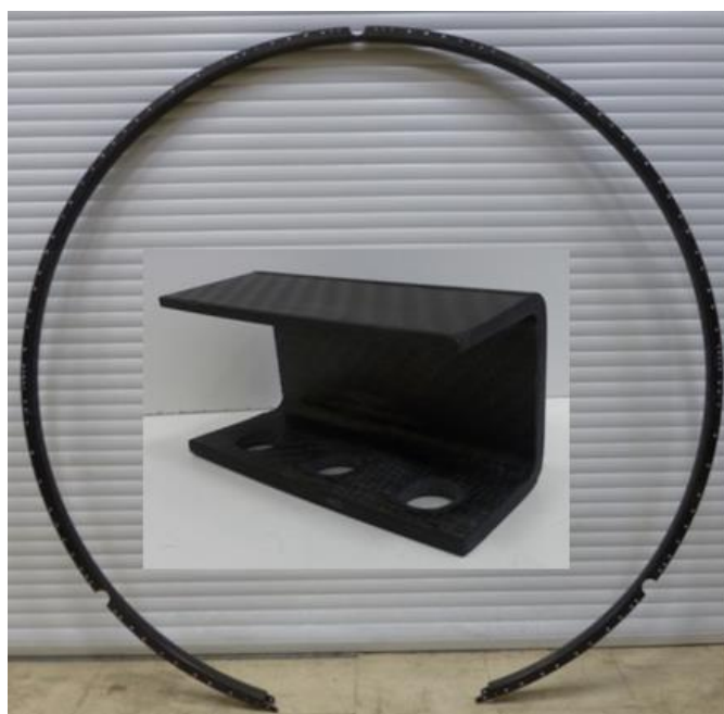
Рисунок 1.11 – Общий вид заднего шпангоута реверсивного устройства, изготовленного по технологии RTM
