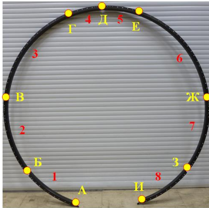
Рисунок 1.17 – Схема закрепления шпангоута и его условное разделение на сегменты, где буквами указаны места жесткого закрепления заднего фланца, а цифрами сегменты, на которые условно разделили шпангоут
