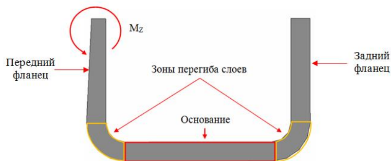
Рисунок 1.20 – Зоны шпангоута отвечающие за его жесткость в осевом направлении
