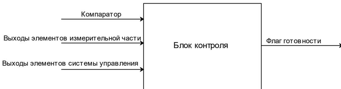
Рисунок 2.29 – Блок контроля
