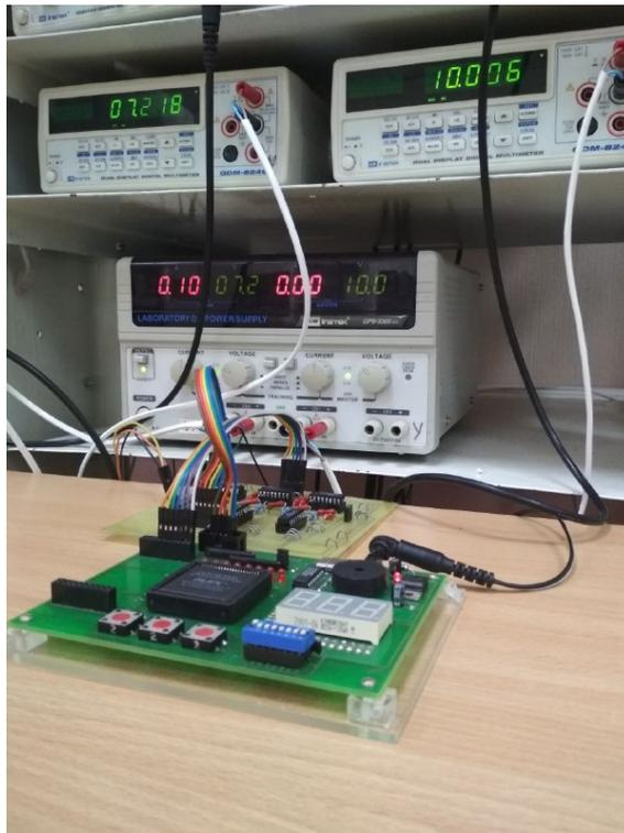
Рисунок 4.4 – Отладочная плата для самонастраивающегося АЦП НС
