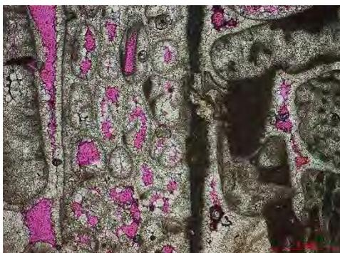
Рисунок 1.1. Фотография фрагмента прокрашенного шлифа (формация Мишриф, шлиф отобран из керна скважины месторождения Западная Курна-2)
